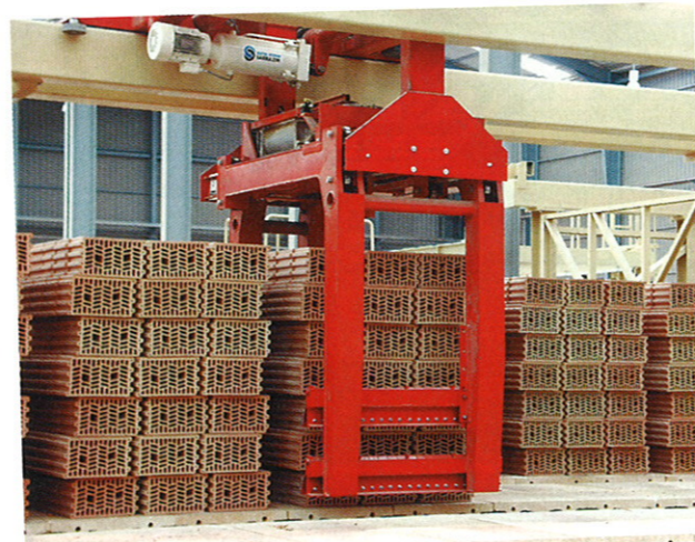
Desapilado de paquetes de bloques termoarcilla
