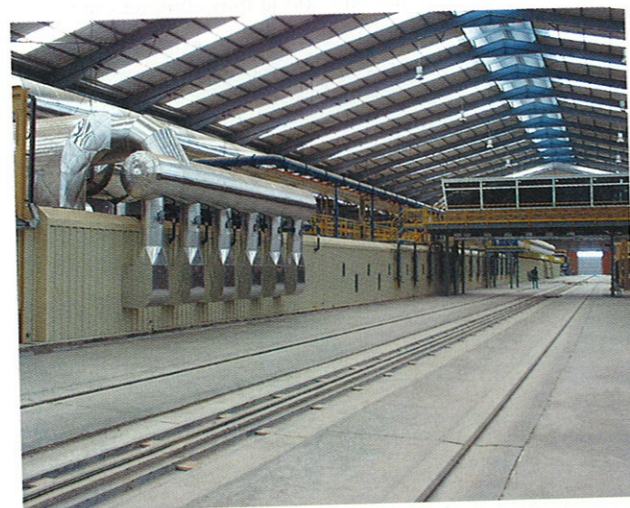
Horno túnel tipo Casing con sistemas flashing y reducción de atmósfera
