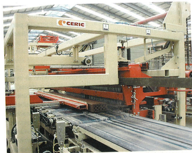
Entrada de los ladrillos caravista al cortador multihilos con biselador
