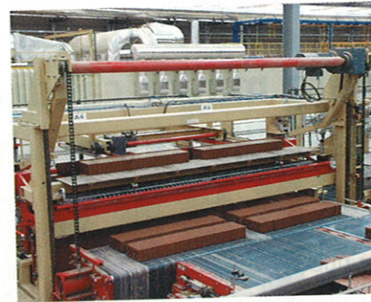
Salida del cortador multihilos con biselador para productos caravista
