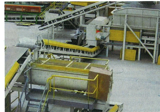
El material pasa de la Amasadora 045C a un pequeño silo regulador previo a la zona de extrusión
