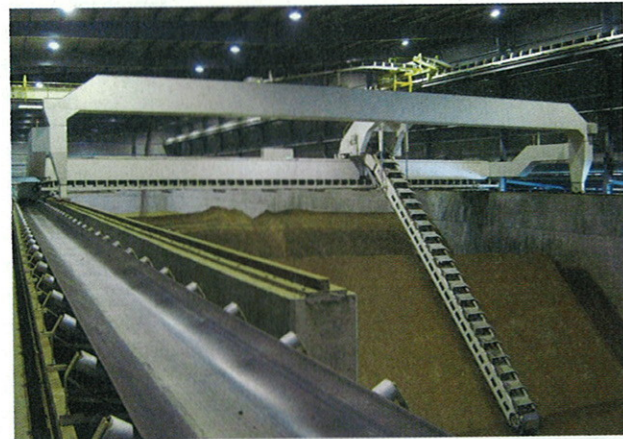
La Draga Puente está instalada en un almacén con capacidad para 35 000 m 3 de arcilla
