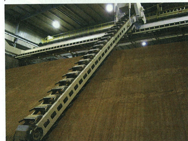
La Pluma de la Draga tiene una longitud de 17 metros y los cangilones tienen una capacidad de 90 litros
