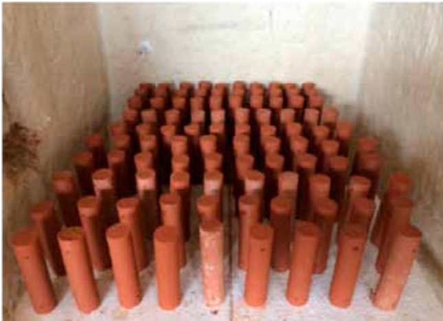
»17 Arrangement of the specimens during firing »17 Anordnung der Probekörper während des Brandes
