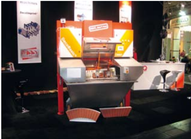
»1 The patented DecoBasic for cutting slips and angle slips »1 Die patentierte DecoBasic für das Schneiden von Riemchen und Winkelriemchen
