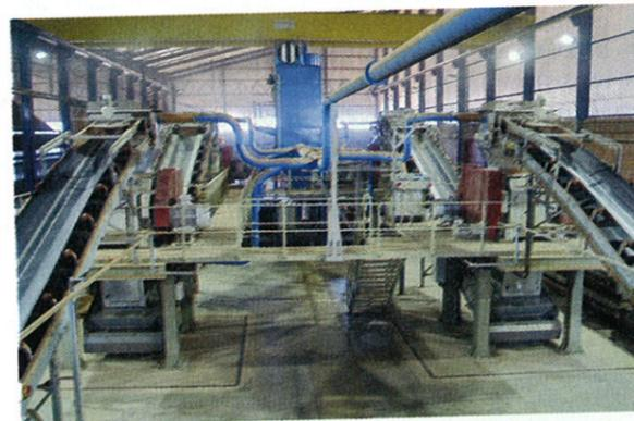
Fig. 5: Cinta transportadora en la preparación de arcilla (margon)
