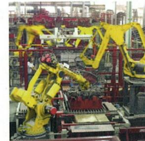
Imagen 3: Descarga por robot a través de diferentes líneas de embalaje automatizado separadas
