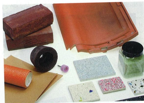
Los productos de cristal en polvo se utilizan en diferentes ámbitos y para procesos de productos diferentes, así por ejemplo se utilizan en la industria de productos incombustibles, en la industria cerámica de ladrillos y tejas y de otros materiales de construcción, en sistemas de combinación de resina, en la industria de la pintura y el barniz y así mismo como abrasivos para materiales especiales.
