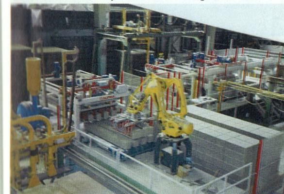
Fábrica de ladrillos Pichler Wels (Austria): Apiladora con robots para bloques huecos rectificadas
