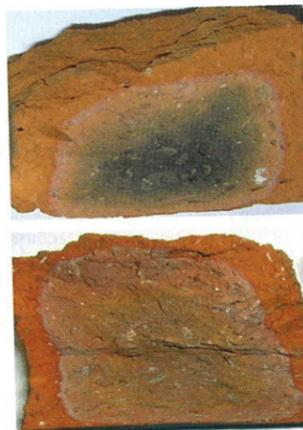
Figura 9. Sección transversal de muestras cocidas a 200°C/h y una meseta a 1.000°C obtenidas de ladrillos con material orgánica gruesa. Arriba) 60min. de meseta Abajo) 240min. de meseta
