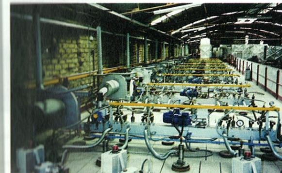
Instalación tipo ASNG/2 – DUPLO funcionando con gas natural o con aceite pesado
