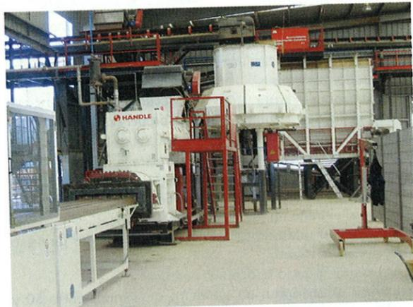
Fig. 1: Equipo de vacío de Händle y alimentador circular de la criba en una fábrica de tejas española
