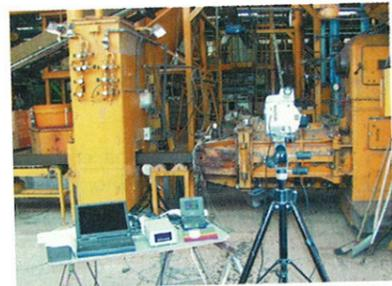
Estructura típica de medición para determinar y registrar los datos de procesamiento (presión, temperatura, velocidad de extrusión, velocidad de atornillado, termografía de la superficie de la extrusora)
