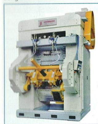
Fig. 2: Prensa mecánica para tejas del tipo Crono 222 con dos módulos
