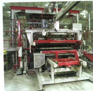
Imagen 1: El nuevo cortador múltiple y biselador de ladrillos con recorte vertical de Lingl
