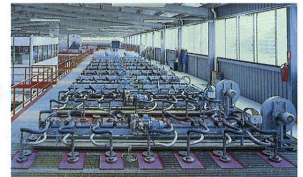
Instalación funcionando con aceite pesado compuesta por equipos a impulsos, tipo NIR/4T y por equipos a gasificación ASN/6
