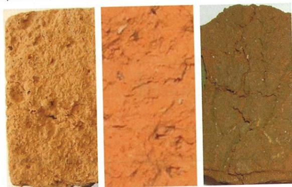
Figura 8. Color superficial de muestras de ladrillos cocidos por 60 minutos. Izquierda) a 800°C. Centro) a 1.000°C. Derecha) a 1.100°C
