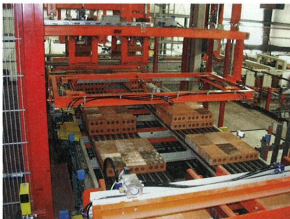
Figura 5: Cadenas de descarga con defacing y línea de clasificación posterior
