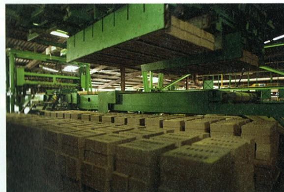
Figura 1: Suministro e instalación apiladora: hasta 11.000 ladrillos se apilan cada hora en la instalación para su cocción
