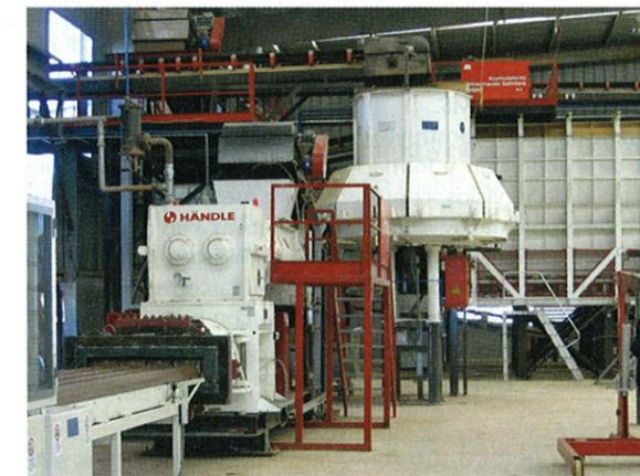
Procedimiento de varias barras – dependiendo del formato de las tejas se pueden extrudir hasta seis barras de forma simultánea
