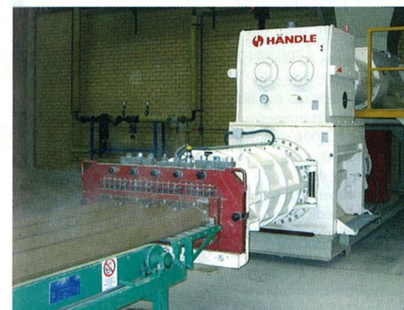
Instalación de formación para tejas de Händle con cargador de criba rotativa BRSH 19b, máquina de extrusión E 65a/65 y mezcladora de doble eje MDVG 1025 f
