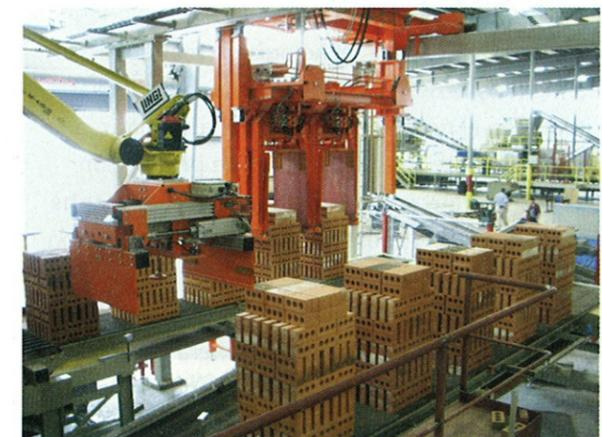
Figura 4: Descarga de paquetes y robot de despilado
