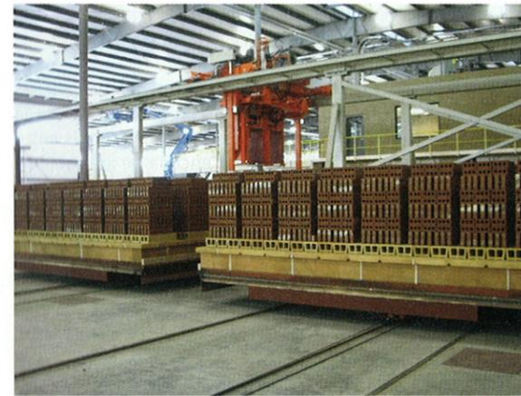
Figura 2: Vista sobre los carros del horno túnel
