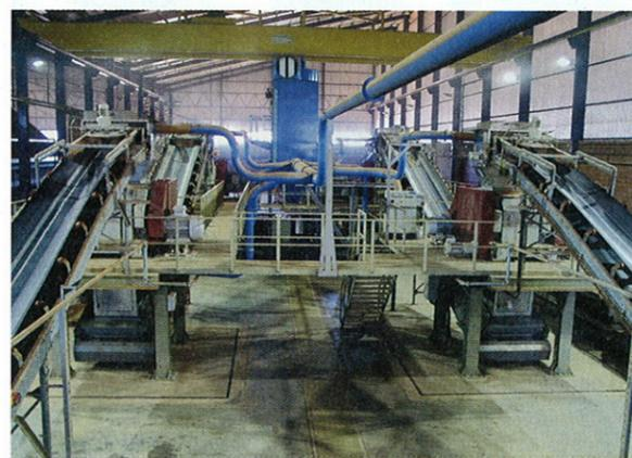
Fig. 5: Cinta transportadora en la preparación de arcilla (margon)
