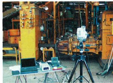
Estuctura típica de medición para determinar y registrar los datos de procesamiento (presión, temperatura, velocidad de extrusión, velocidad de atornillado, termografía de la superficie de la extrusora)
