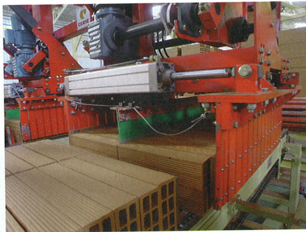
Formación de capas para el paletizado de ladrillos
