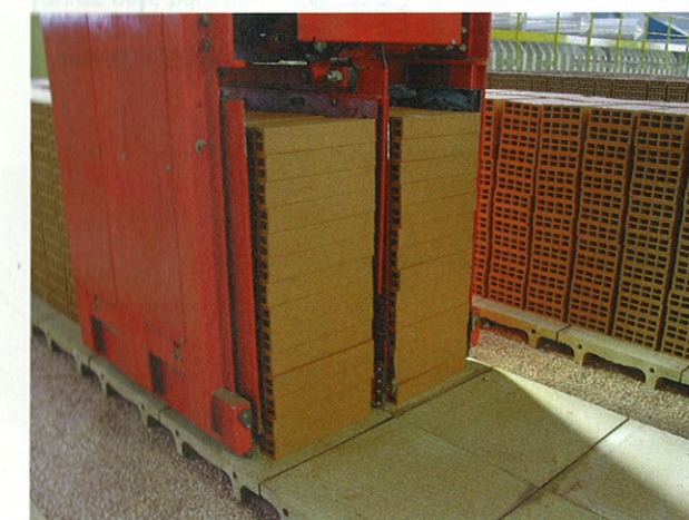
Descarga automática de paquetes de ladrillos
