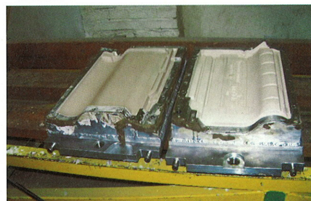
Fig. 2: La teja de la fig. 1, moldeada en yeso
