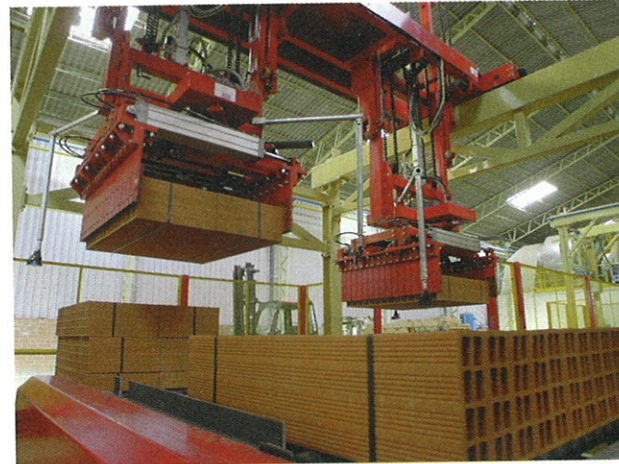
Flejado de las capas de rasillones y paletizado
