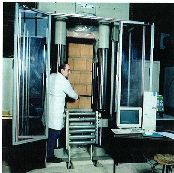
Photo 1 : essais de murs sur presse de 6 000 kN
