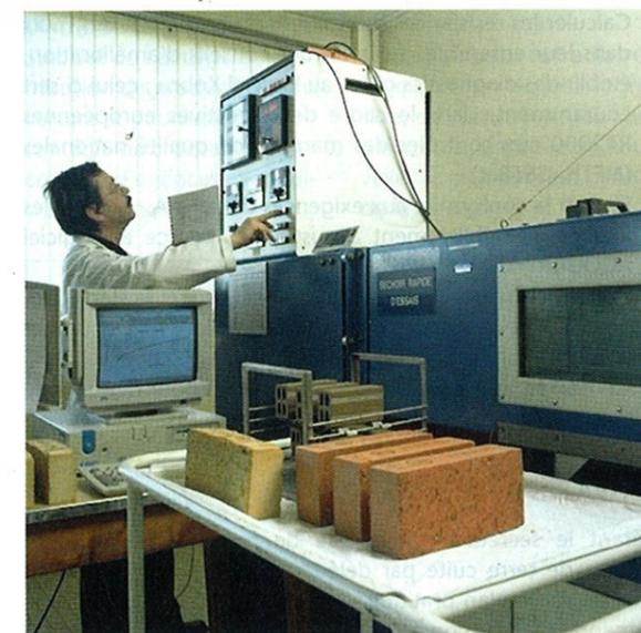
Photo 3 : séchoir expérimental programmable
