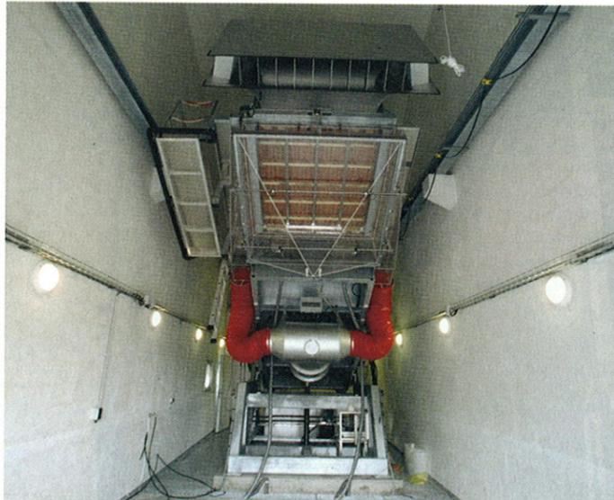
Photo 4: La soufflerie «Moby Dick II» permet de contrôler des toitures dans différentes conditions météorologiques
