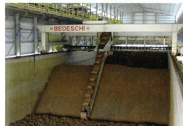
Fig. 1: Escavatore a tazze tipo BEL C dell'impianto Holly Hill
