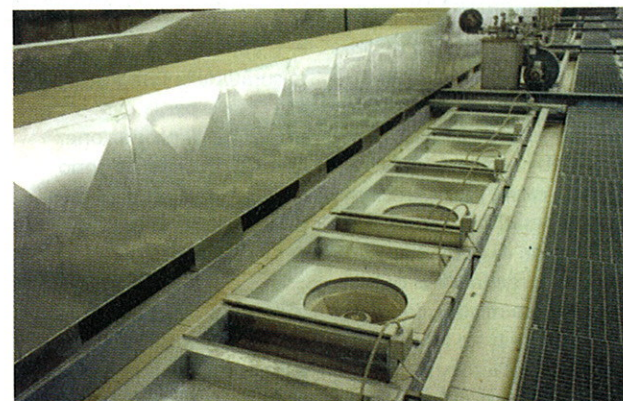
Dettaglio volta dell'essiccatoio: in primo piano i motori comando ventilazione interna
