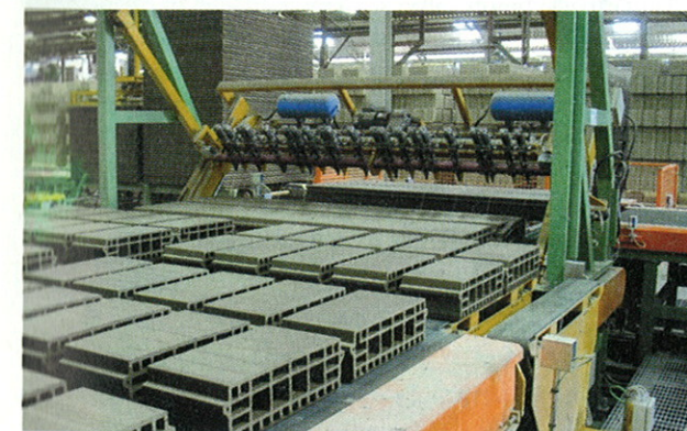
Dettaglio volta dell'essiccatoio: in primo piano i motori comando ventilazione interna
