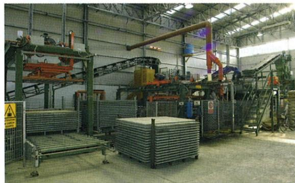
Fig. 8: Il sistema pressa con trasportatore per essiccatoio (di fronte a sinistra)
