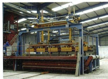
Fig. 2: Promag II (Algeria): impilatrice automatica a cinque teste per carico blocchi forati
