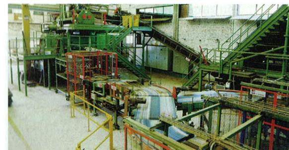
Fig. 6: Impianto di taglio e alimentazione gallette per tegole da Tecno.Sa.Mec.
