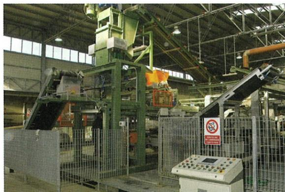
Fig. 4: Linea di formatura per pianelle
