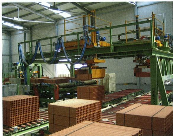
Automatizzato di scarico a strati per tavelloni
