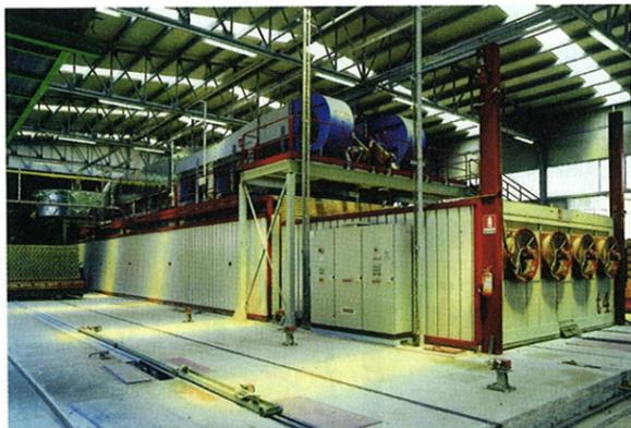
Fig. 2: Forno a tunnel per « mattoni a mano » da IPA International
