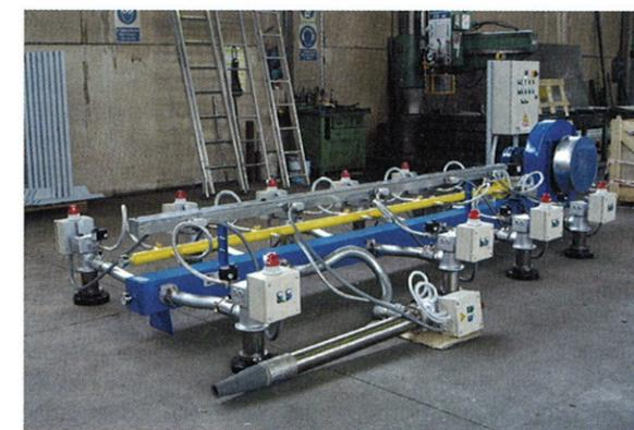
Fig. 7: Bruciatore in volta per gas tipo Tecno-Fire ad alta velocità da Tecno.Sa.Mec.
