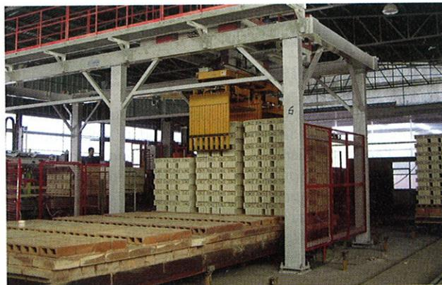
Fig. 1: La nuova pinza di scarico rende possibile ridurre in modo considerevole i cicli dell'intera linea produttiva
