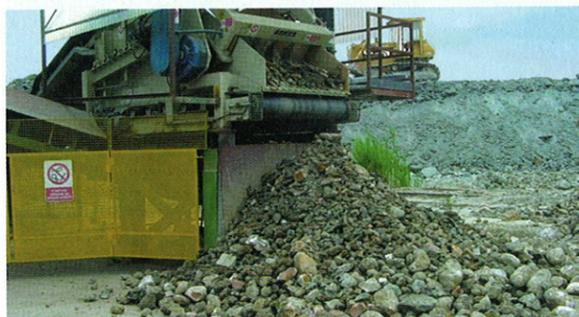
Fig. 4: Vaglio combinato VCA installato in cava per rimuovere le pietre da IPA.LA.KER
