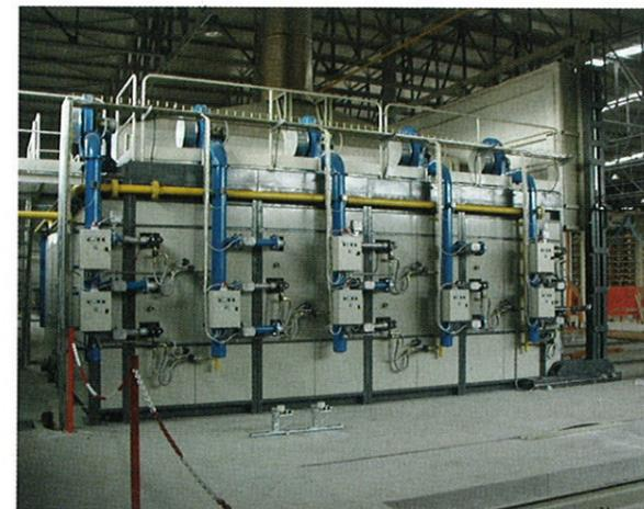
Fig. 1: Forno intermittente con bruciatori laterali ad alta velocità da IPA International
