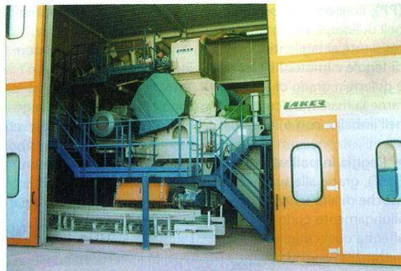
Fig. 3: Laminatoio veloce LB1212 installato in cabina insonorizzata da IPA.LA.KER
