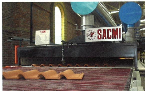
Fig. 1: Il forno monostrato della Sacmi
