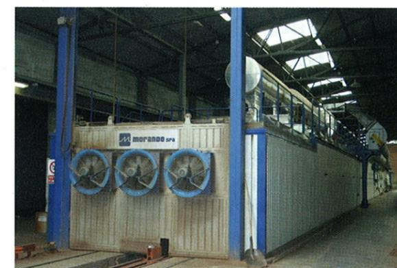
Fig. 12: Tutti i prodotti vengono cotti per 50 ore in uno dei due forni a tunnel
