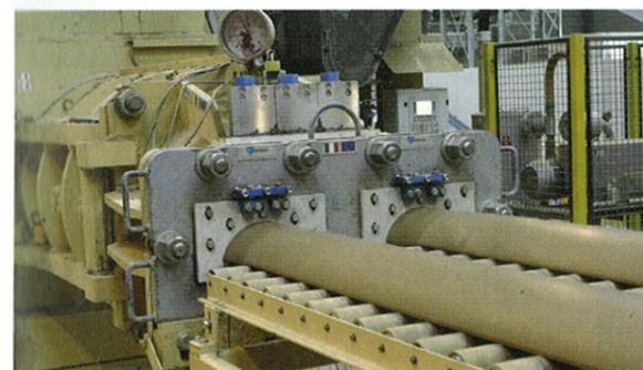
»1 Estrusione in doppia uscita delle gallette preformate per tegole Tuile Canal
