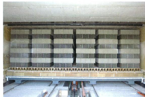
Forno a tunnel per la cottura di mattoni da muratura
