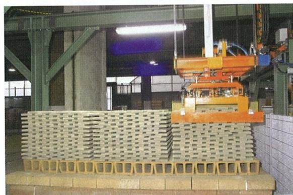
Linee di produzione per lastre da pavimento
