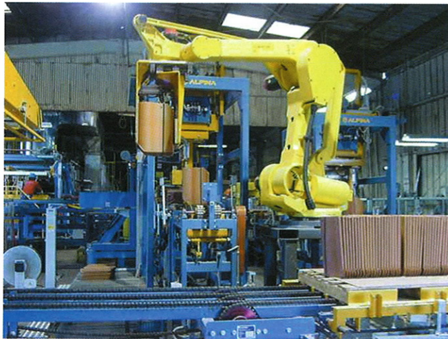
用6轴机器人给烧结瓦打包的系统
