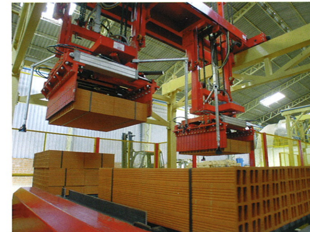
夹住多孔砖作垂直运动的码坯机
