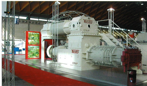
“Combi”078型真空挤出机特别适合大规模生产
