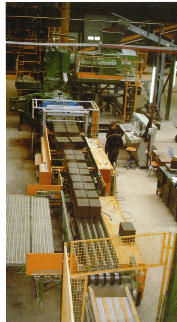
图1 多泥条切坯机
