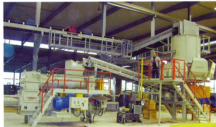
Händle PZVMGD45a/35920e 型双轴挤出机和 BRSH19b 型圆筛喂料机
