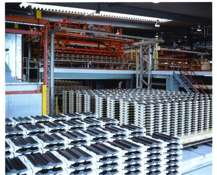
10.4小时后窑车离开隧道室并送往卸车机处
