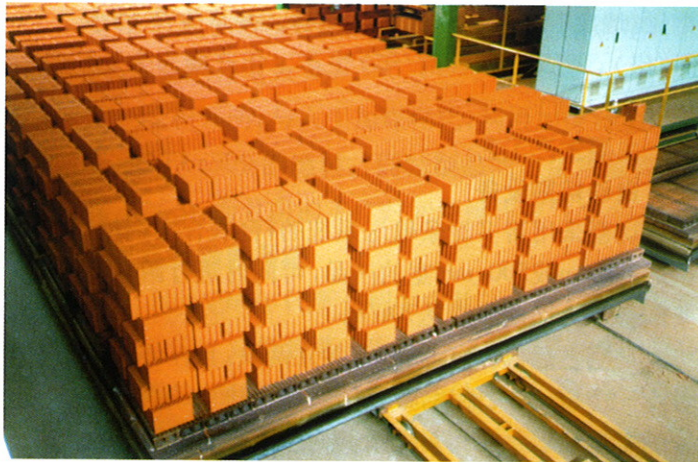
图3 码好的窑车准备焙烧
