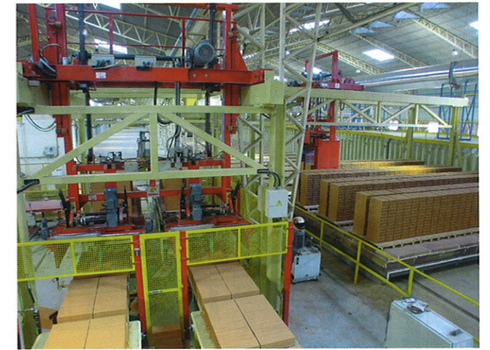
隧道窑车自动卸砖（俯视）
