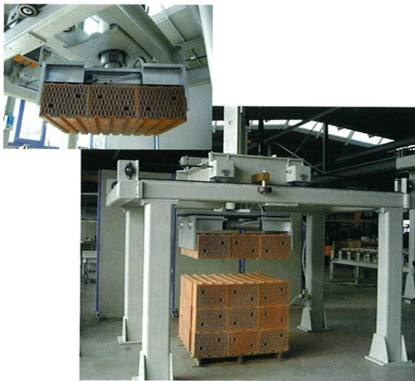
码砖机的旋转装置
