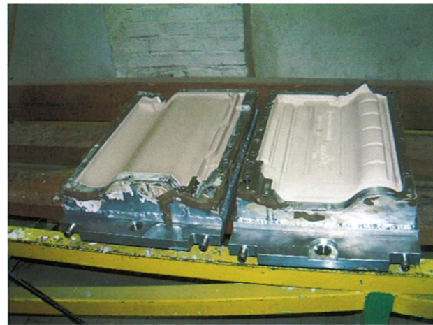
图2 模压成型的瓦坯
