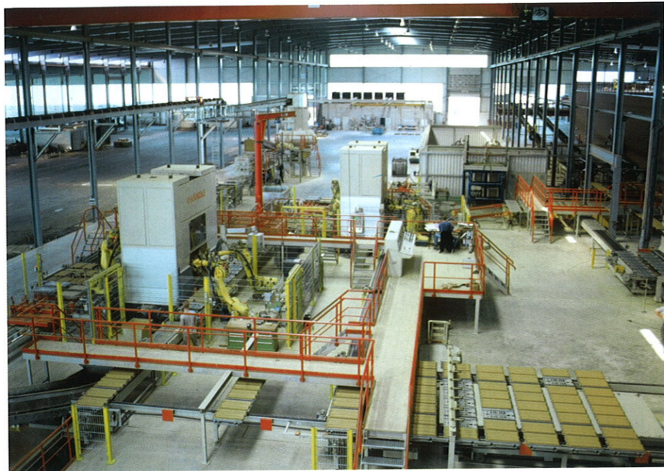
标准屋面瓦成型: Keller 机器人技术用于压制屋面瓦的码、卸
