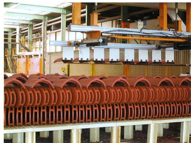
图3 配瓦直接放在两层平瓦垛顶上焙烧
