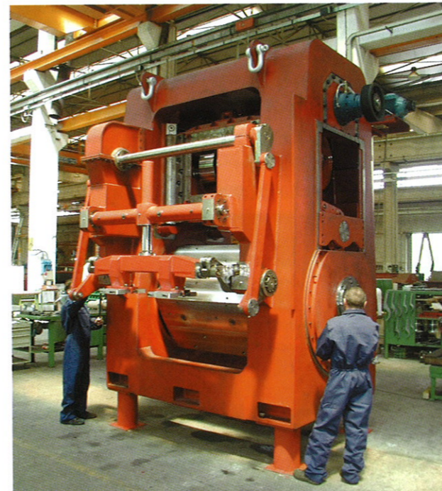
TP2002型新型屋面瓦压机
