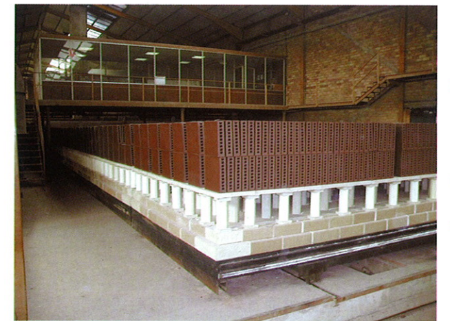
在西班牙码垛宽 5m、长 120m 的隧道窑, 年产 200 万 m 2 劈离砖
