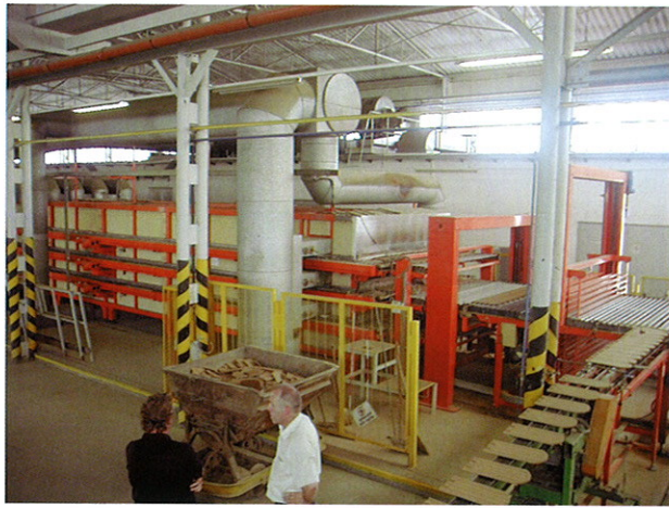
在捷克 Tondach 的 141m 长三通道辊道窑, 年产 1650 万块平瓦, 烧成周期 4-6h
