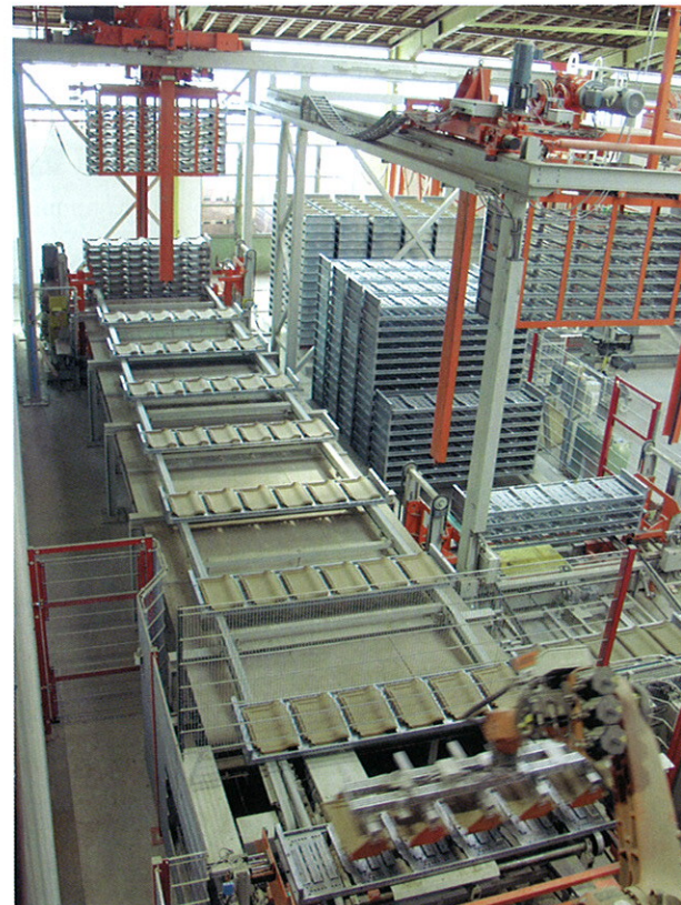
装有坯的托架垛，输送装有干坯的托架垛，为便于机器人操作排成行
