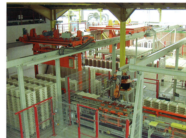
卸下隧道窑车上的 H 型匣钵堆垛储存
