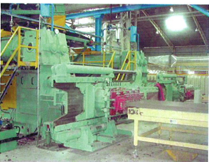
两个 076-RB 联合真空挤出机装有压机口和带移动装置的机头
