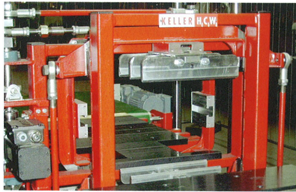
为通用切割机新研制的倒角装置
