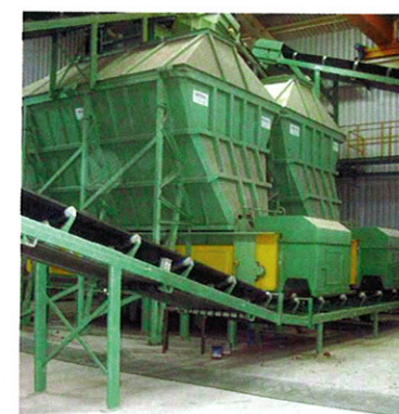
原料土经过 028 型链板式箱式给料机时计量体积
