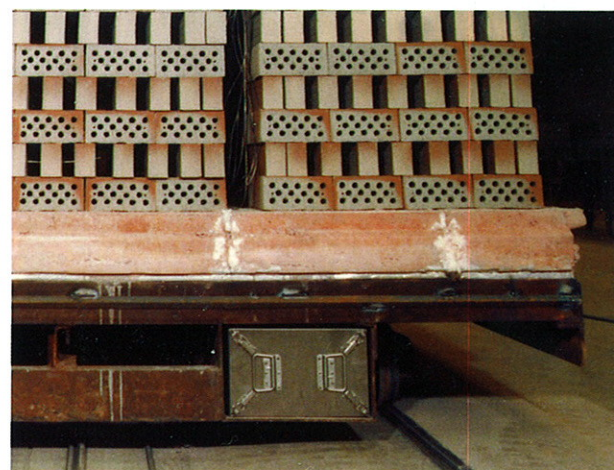
在隧道窑车下的 Datapaq 系统
