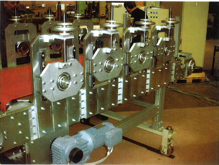
糙化装置配有四个仿形辊，各有各的驱动
