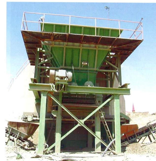
粘土用一台 118-DT 型辊式破碎机初破
