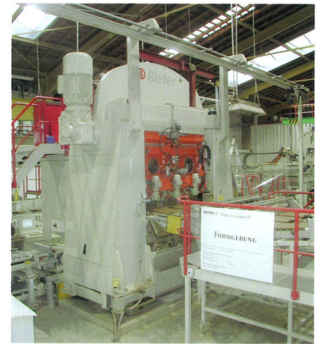
在利特 DR6 型屋面瓦压机上, 每一轮面上的三个 Magnum 型工作模一个挨一个安装
