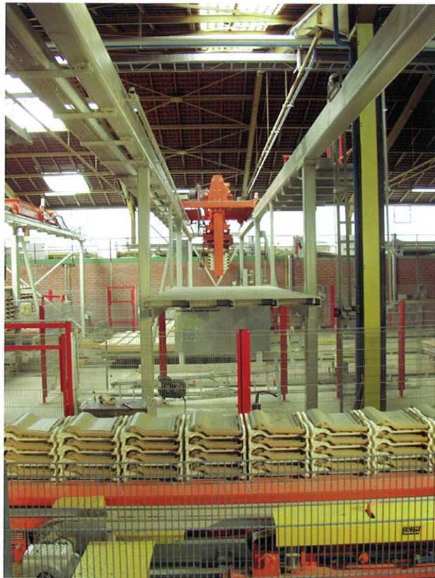
隧道窑上装有 H 型匣钵的码垛
