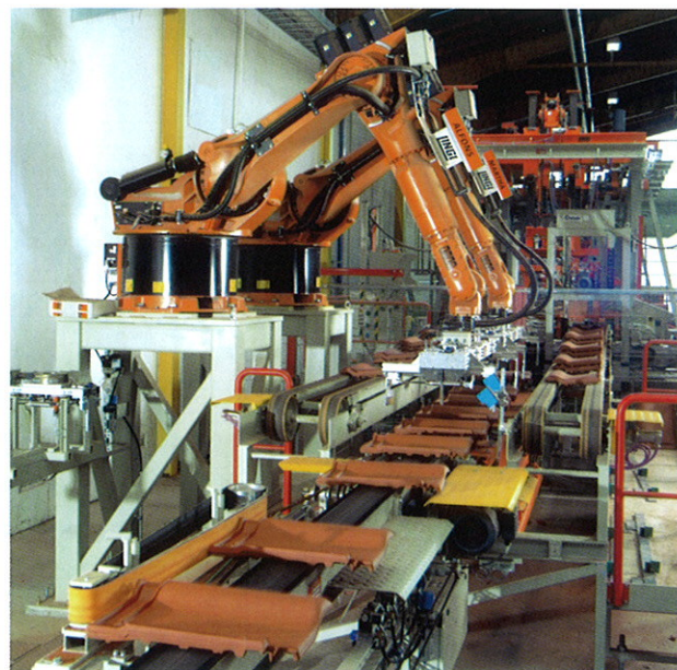
两个机器人一起把四块瓦纵向移到皮带输送机上
