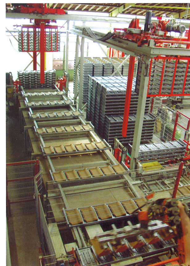
装有坯的托架垛;输送装有干坯的托架垛,为便于机器人操作排成行
