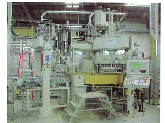
DTP3 型配瓦压机可以配 3 个、2 个乃至 1 个下模
