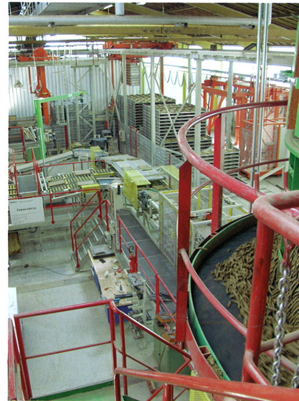
粘土瓦毛坯送往旋转式和转台式压机
