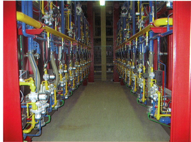
侧烧隧道窑装有 30 个高速烧咀,20 个在坯垛下,10 个在坯垛上
