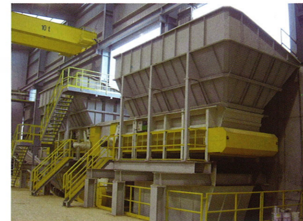
两个 029P/6 型喂料机把料卸入 119DT 型初碎机
