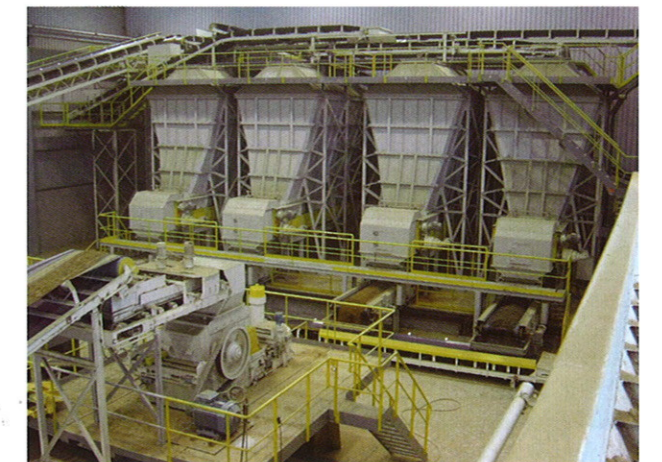
四个带重力供料系统的 028P/6 型箱式喂料机制备
