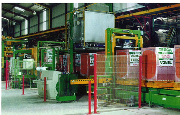
带水平和垂直捆扎及四面有收缩薄膜包装的打包机
