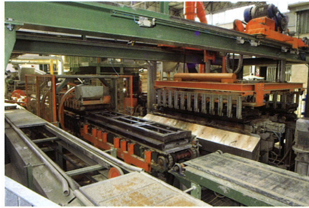
图2 压制瓦的脱模
