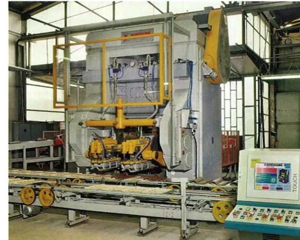
设计最大产量为每小时3000块的 Bongioanni 的 Crono 222 型压机
