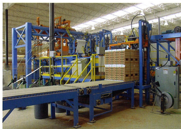
挤出清水墙砖的打包,用右角支撑保护,不用木制货盘(Geric)
