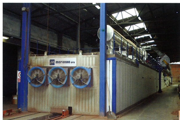
图10 所有的制品在Pratigliolmi的两个隧道窑中的一个里焙烧50小时
