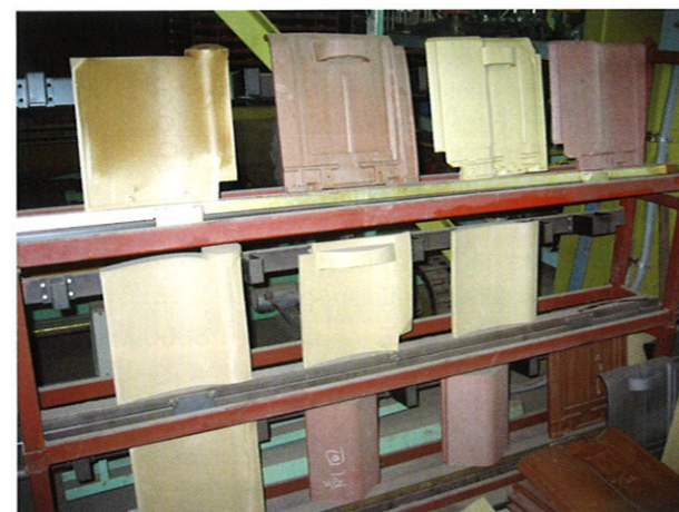
所有特殊的形状在一个压瓦生产线上生产。干燥架设计成可以接合多种形状压制系统。
