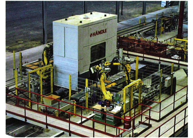
带有4个上模最高产量为4400块瓦的 Händle Nova 2 (PDR1220A) 压瓦机
