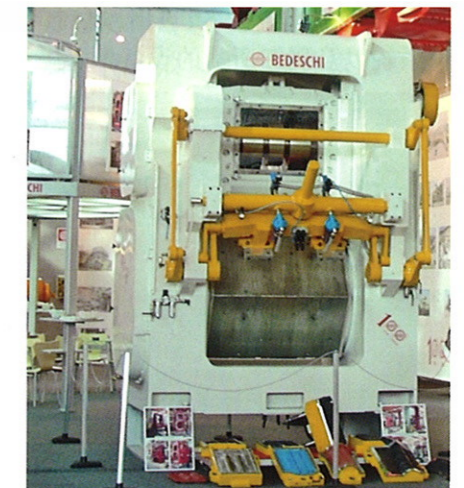
压力为 160t 的 Bedeschi 公司 TP2 型液压瓦机
