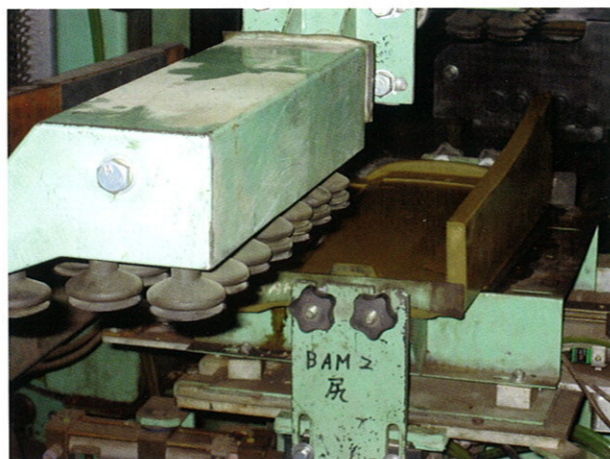
不同形状的瓦可以在一条压制生产线上加工。
