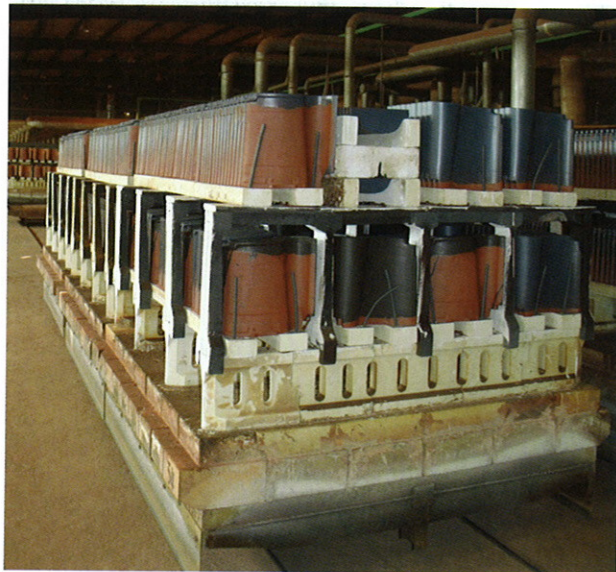
标准瓦及配瓦一起放置在一个隧道窑车上
