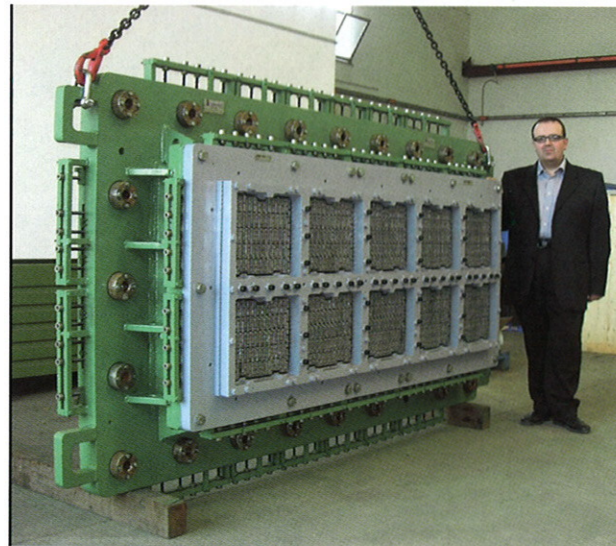
Filiere Torres 总经理及 Giovanni Sandri 技术总监, 站在用来生产绝热砌块、超越传统的 10 出口大型挤出模具旁
