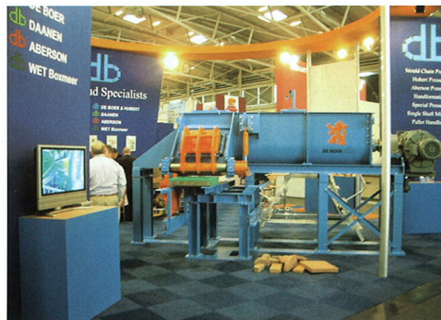
De Boer 提供的可以生产标准砖和异形砖的机器
