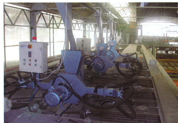
图 4: 焙烧系统由两行烧嘴组成。每组配备电板、热电偶及温度调节器, 因而都是单独可控的
