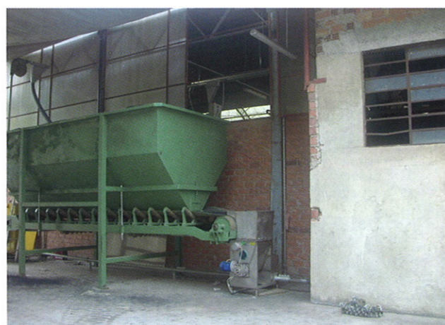
图 2: 体积为 6 \text{m}^3 到 8 \text{m}^3 的箱式喂料机可进行粒度控制。初级破碎机位于箱式喂料机后, 将粒度减小到 5mm 以下
