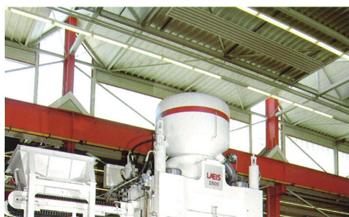
Laeis HPF 111 2500 型自动液压机可生产双层耐火材料制品
