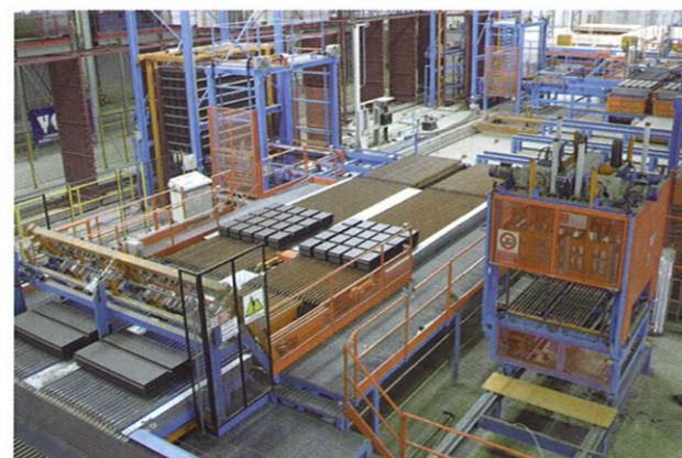
图 2: 坯体的切割和码装区以及烘干制品的卸载
