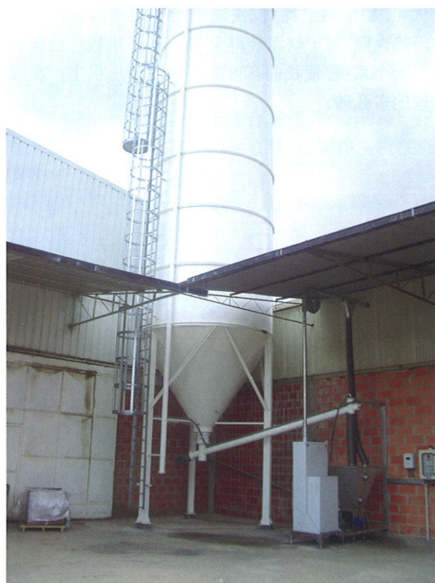
图 3: 粉状焦炭存放在仓内, 通过一个自动控制的机械系统传输到窑顶
