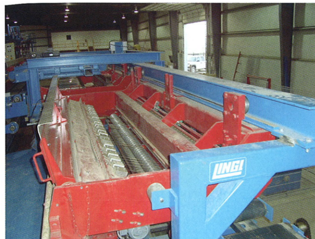
图 2: 带有更换框和倒角辊的多钢丝切割机
