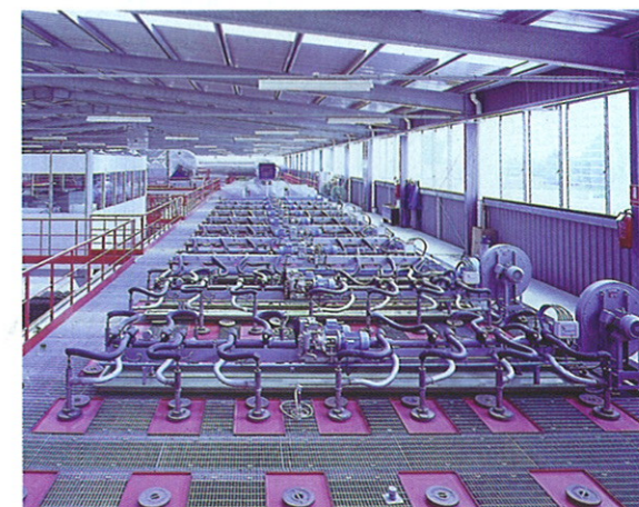
图 2: 使用重油的设备带脉冲烧嘴 NIR/4T 和气化烧嘴 ASN/6
