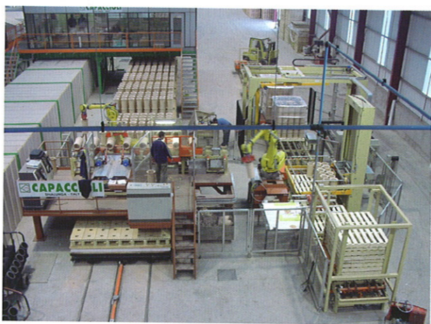
图5 生产玻化粘土管的生产设施
