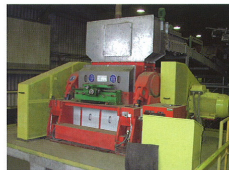
图 4 装有辊子切削车床的铰链式细碎对辊机
