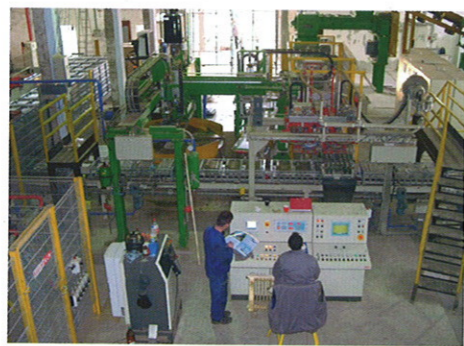
图 2 压制配瓦(转盘式压机)或挤出屋面瓦片(凯乐 hew 屋面瓦压机)被码放到转运架上
