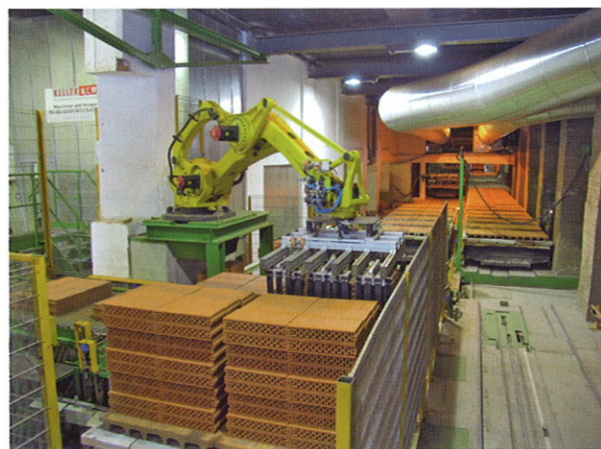
图6 机器人卸载砌墙砖(凯乐 hcw)
