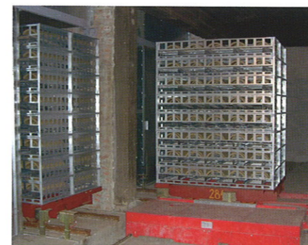
图 7 在干燥室出口待转运的满载干燥车架
