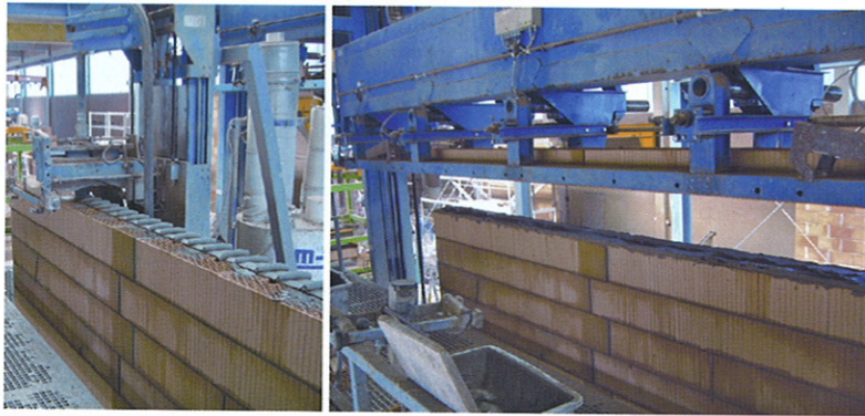
图 1 一码放夹具将砖层码放到位
