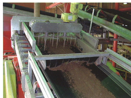
图 3 带布料机(“Synchroquirl”)的皮带输送机
