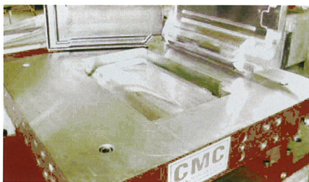
图 4 产品在钢模里压制
