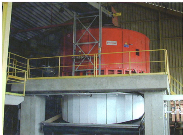
图 2 带卸料槽和集料带的湿式轮碾机
