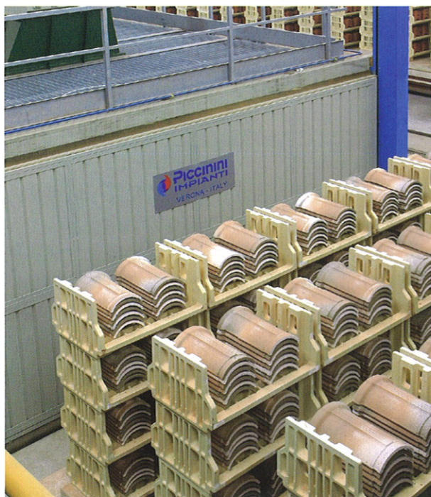
图5 入窑前,窑车先通过预热室
