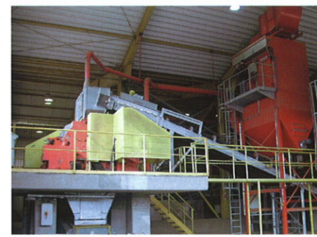
图 5 带收尘系统的铰链式细碎对辊机
