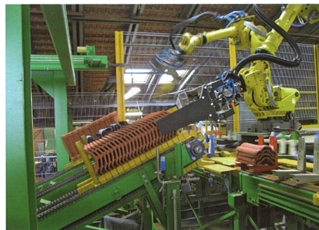
图7 创新的粘土屋面瓦卸载和分拣(凯乐 hcw)
