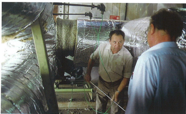
图6 第一次加热试验时的温度测定,共有 12 个测点
