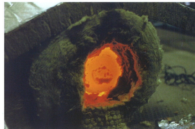
图8 二次燃烧设备的加热试验(在 t_7 = 875^\circ\text{C} 时去除隔热的观察)
