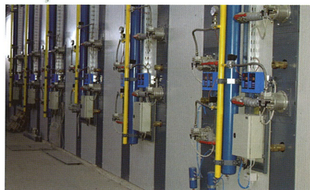
图12 用新概念的燃气烧嘴可以实现相当大程度的节能
