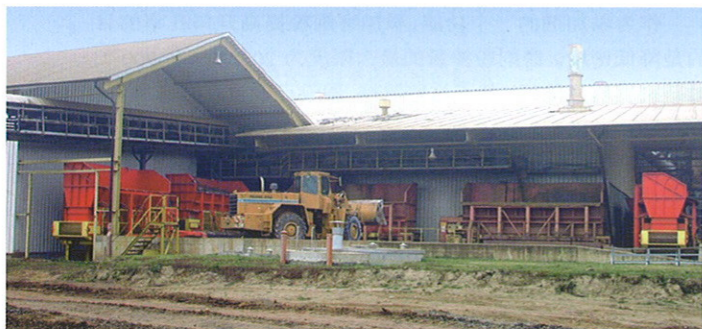
图 1 箱式喂料机：通过输送带和前置式装载机上料
