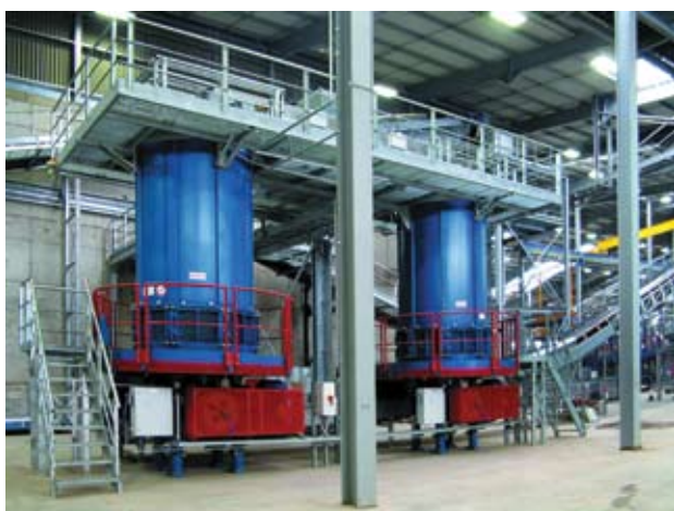
» 1 Многофункциональный круговой ситовый питатель «BRSH 19с» для буферизации, смешивания, гомогенизации и увлажнения шихты
