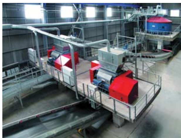
» 2 Смесительные бегуны мокрого помола «Quadro HMIQ 2170с» и две линии тонкого помола – вальцы типа «Beta WF 10120е»
