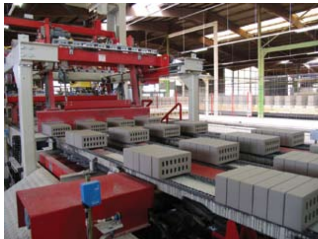
» 7 Сортирующий транспортер перед подающим столом участка пакетирования
