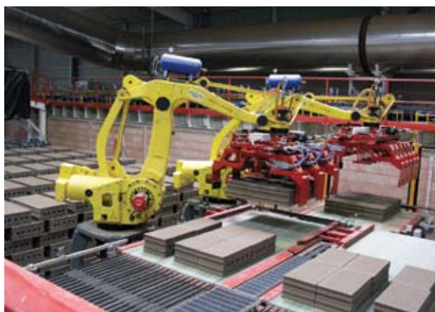
» 7 Роботизированные захваты размещают сухой продукт согласно заложенной программе
