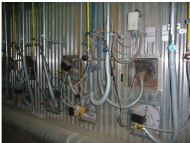
» 5 Пример совмещения действующих ранее горелок с высокоскоростной техникой Лингл
