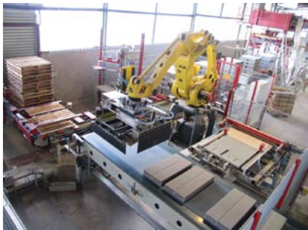
» 8 Роботизированный укладчик с комби-грейфером и присосками для захвата бумаги
