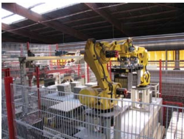
» 4 Позиция загрузки печных вагонеток, роботизированные грейферные установки
