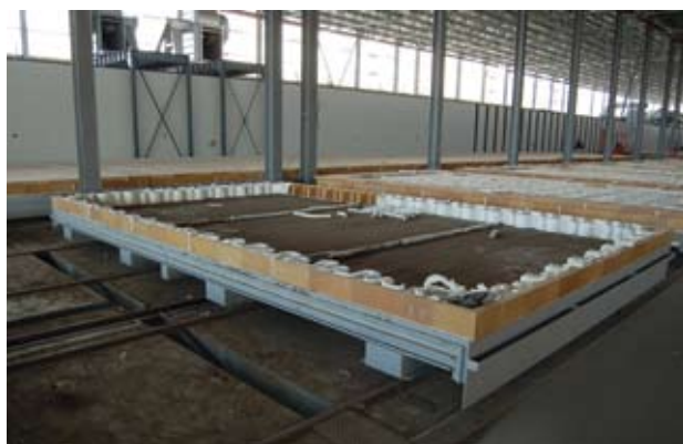
» 6 Печные вагонетки – кольцевая конструкция боковых перекрытий
