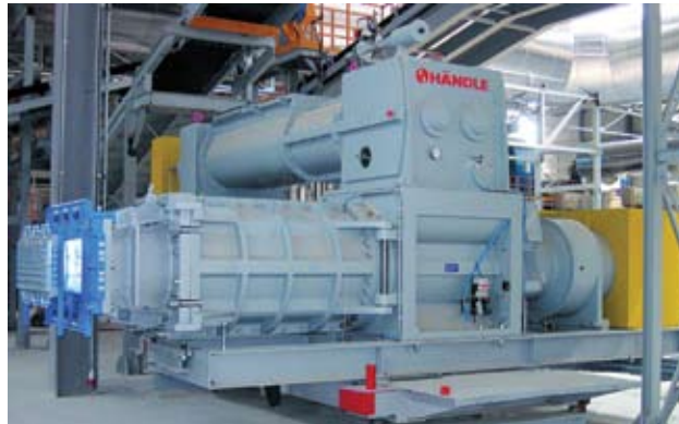
» 3 Модель Futura II типа E75a/70v сочетает вакуумно-экструзионную машину с двухвальным вакуумным глиносмесителем типа MDVG 1025f производства компании Händle
