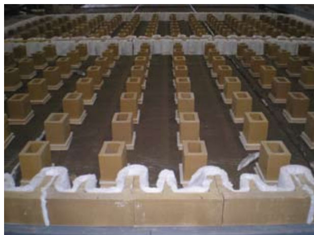
» 7 Сборка печной вагонетки – укладка огнеупорных труб
