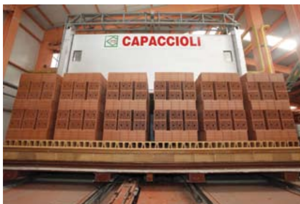
» 11 Печь производительностью 750 т/день блоков (г. Ящи, Румыния)
