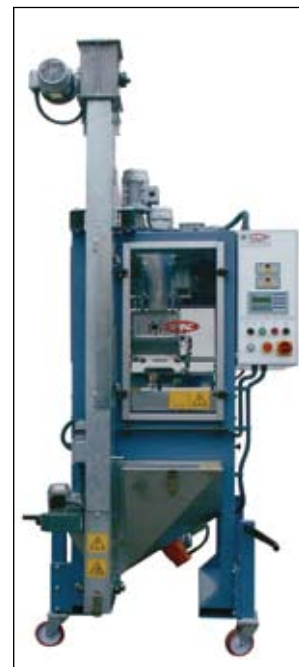
» 3 Установка StabliDry используется для сухого декорирования
