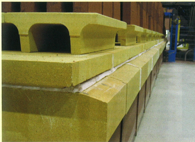
Пайн Халл, Джорджия, США | Вагонетка туннельной печи с низкими бордюрными блоками BurcoLight
