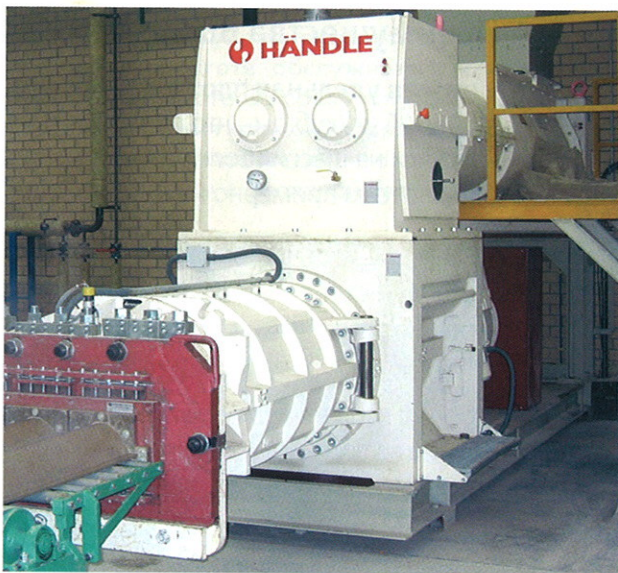
Ленточный вакуум-пресс, в состав которого входит ленточный пресс Futura II Тип E 65a/60 с вакуумной двухвалковой мешалкой, тип MDVG 1025f
