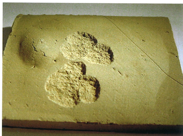
Рис. 4: Вспененный при сушке образец с отколовшейся частью
