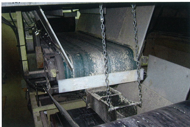
Рис. 6-а и 6-б: Устройство для измерения влажности глины типа TFM 1, специально сконструированное для глины и суглинка
