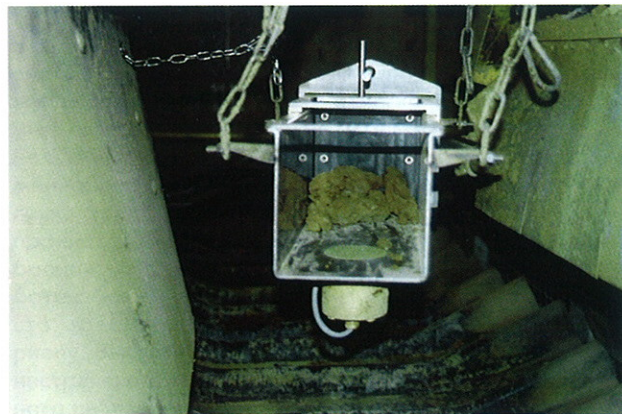
Рис. 6-а и 6-б: Устройство для измерения влажности глины типа TFM 1, специально сконструированное для глины и суглинка
