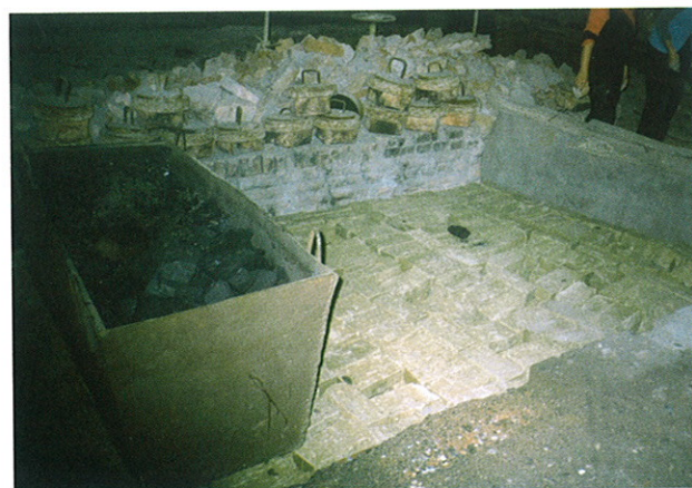
Загруженная земляная кольцевая печь, не хватает только верхнего слоя кирпичей, уплотняющего слоя глины, камней для ходьбы и железных элементов для отверстия для поддува
