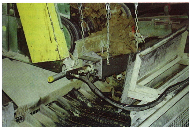
Рис. 7-а и 7-б: Запатентованное электромеханическое приспособление прибора TFM 1 уплотняет материал при постоянном давлении
