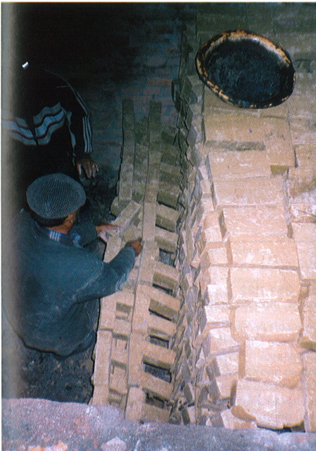
Место для загрузки в земляной кольцевой печи: неплотная загрузка и оболочка с мастикой для поддержания огня
