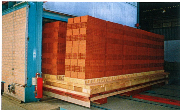
Выходной конец туннельной печи
