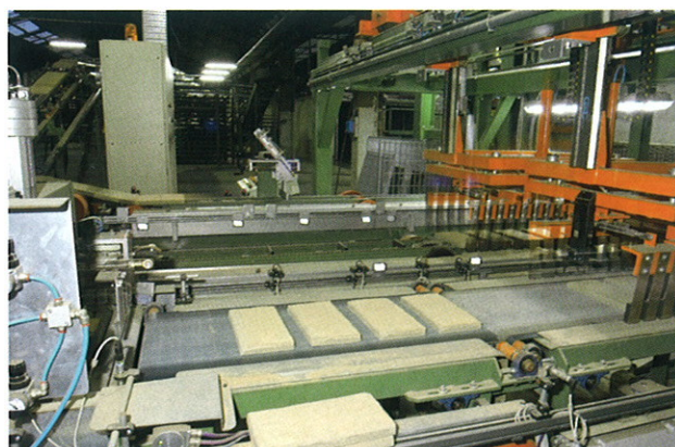
Участок укладки напольной плитки автоматом садки на печные вагонетки
