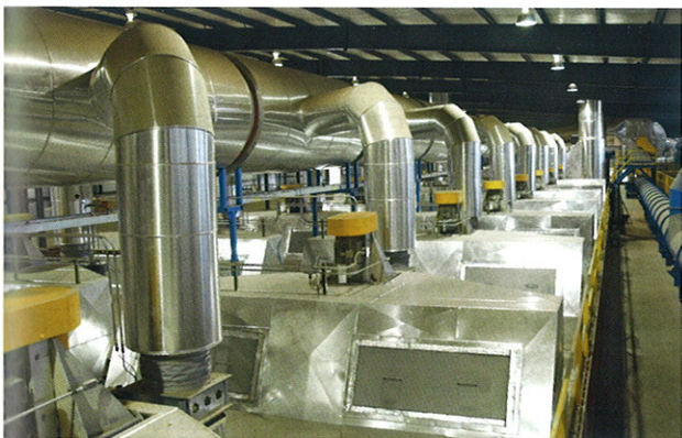
Рис. 5: Системы сушилок с рециркуляцией
