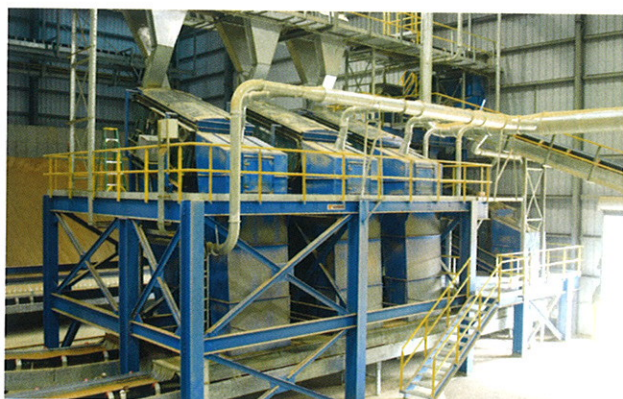
Рис. 2: Грохоты на участке массоподготовки
