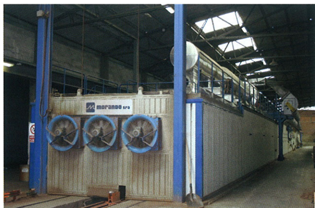
Все продукты обжигаются в двух туннельных печах в течение 50 часов
