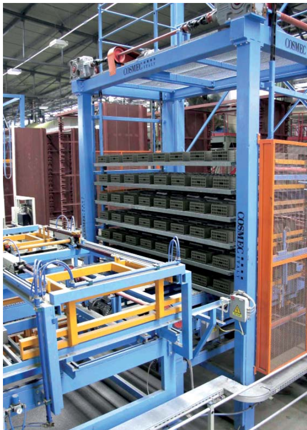
Рис. 3 Автоматическая разгрузка высушенного материала
