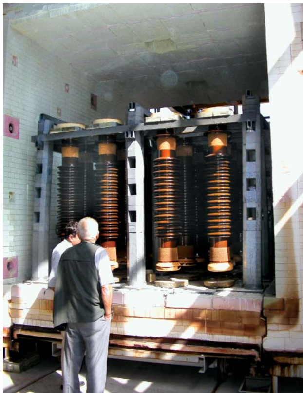
» Установка печного припаса для обжига фарфоровых электрических изоляторов
