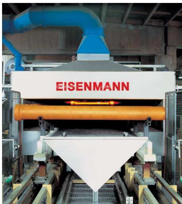
» Специально адаптированная туннельная печь для обжига с призматическим конвейером для глазурованных керамических труб, которые продолжают вращаться и в зоне высоких температур
