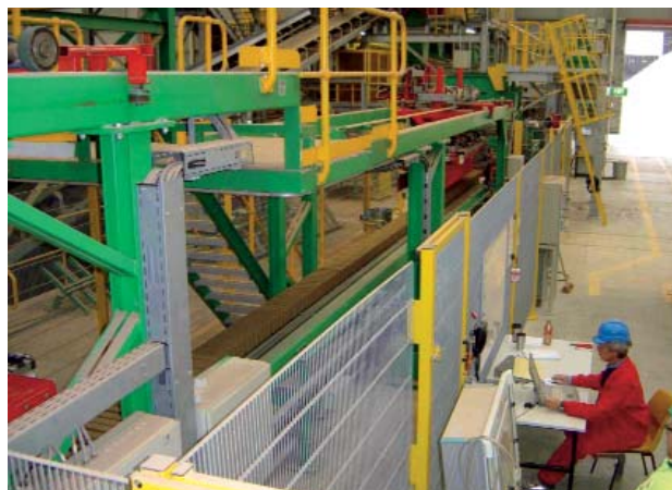
Рис. 2 Транспортировка сырой продукции: конвейер группировки кирпича
