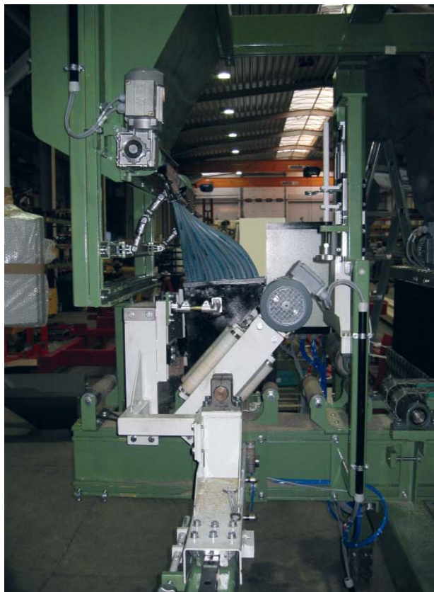
» Нанесение песка на три стороны глиняного бруса
