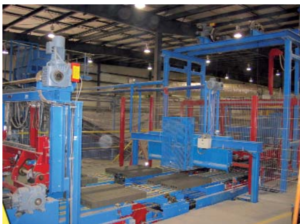
» Конвейеры Lingl с устройствами для текстурирования кирпича песком
