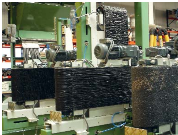
» Ленты для нанесения рельефа придают каждому кирпичу его индивидуальную структуру поверхности
