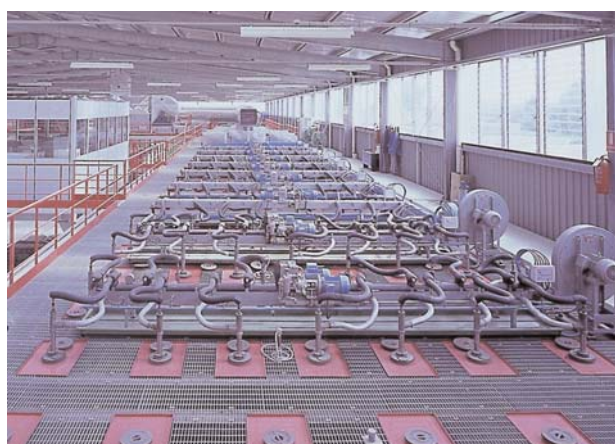
» Установка, работающая на мазуте, имеющая как импульсные горелки типа NIR/4T, так и горелки для газифицированного топлива типа ASN/6
