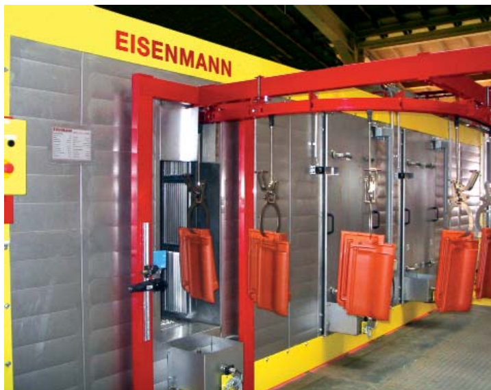
» Печь для обжига кровельной черепицы карусельного типа
