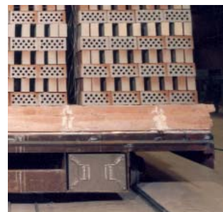
Рис. 2 Теплозащитный контейнер под тележкой туннельной печи
