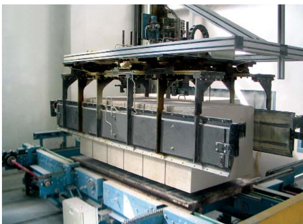
» Транспорт тяжелых изделий осуществляют роботизированные системы: по роликовым конвейерам, при помощи автоматизированной транспортной системы (FTS) или подвесными электроприводными конвейерами
