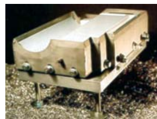
» Съемный пуансон (с резцом и присасывающей плитой)
