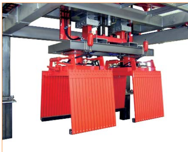
Рис. 2 Разгрузочный механизм со сдвоенной головкой
