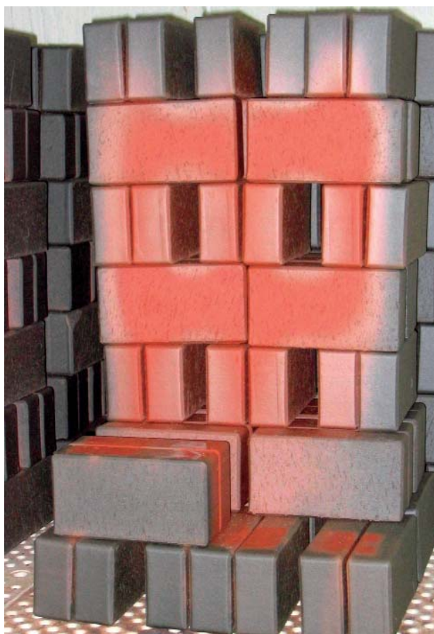
» Стопка кирпича, обжигаемого с восстановлением газовой среды
