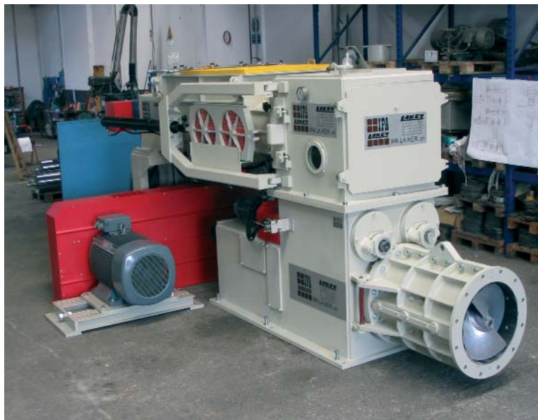
» IPA.LA.KER: Формовочный пресс с двухвалковым смесителем типа LKVD 550
