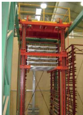
Рис. 3 Оборудование для загрузки сушильных тележек, послойная погрузка
