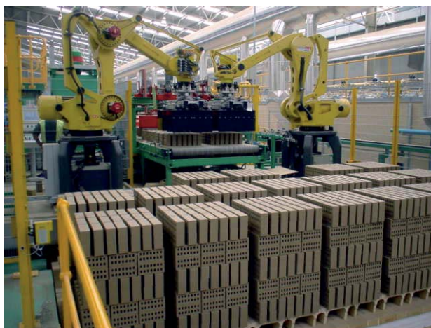
Рис. 5 Укладчик и робот для укладки кирпича на печные вагонетки
