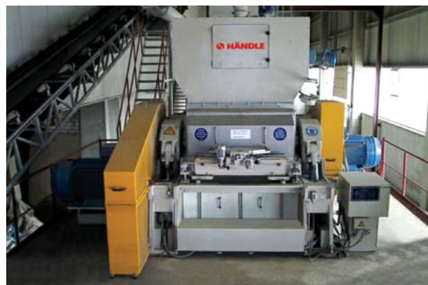
» Валковая мельница тонкого помола Alpha II, тип WFZH 8150d производства Haendle
