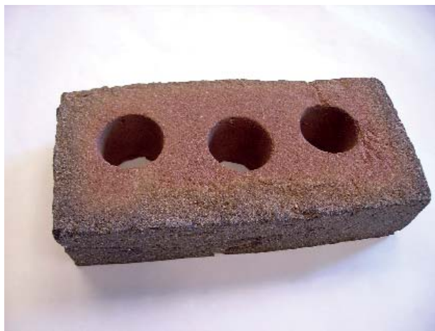
» Кирпич “под старину” с грубой поверхностью, изготовленный методом пластичного прессования
