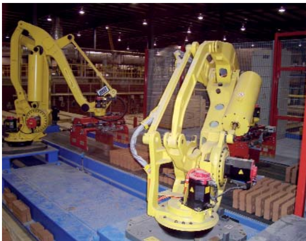
» Робот-садчик, процесс формирования обжиговых пакетов
