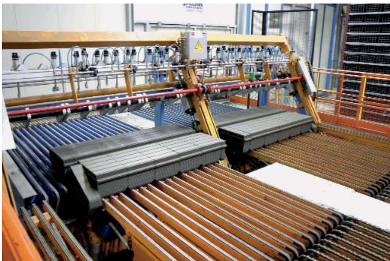
Рис. 1 Резка блоков перекрытия на этапе многократной резки
