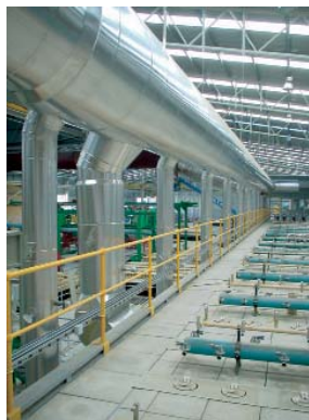
Рис. 6 Туннельная печь с верхним расположением горелок
