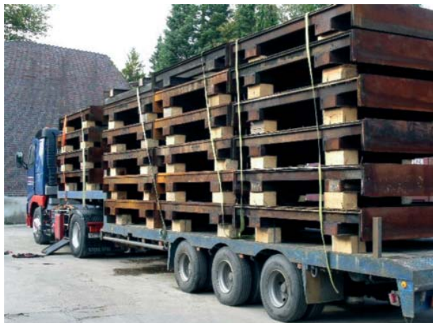
» Печные вагонетки из-за их габаритов пришлось отправить на низкорамных тяжеловесных прицепах
