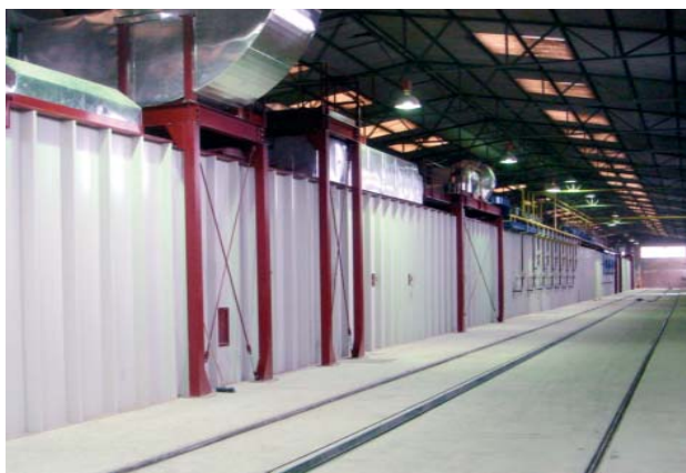
» Печь длиной 119 м и шириной 5,8 м с полезной нагрузкой 2 м.
