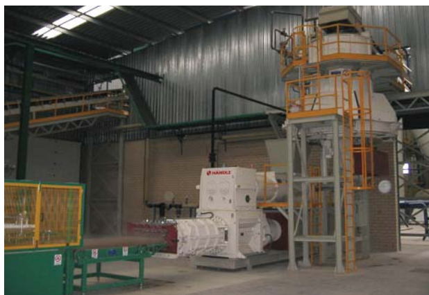
» Формовочная установка Haendle, состоящая из вакуумного экструдера E65a/ 60/ MDVG 1025f и питателя с круглым ситом, тип BRSH 19b
