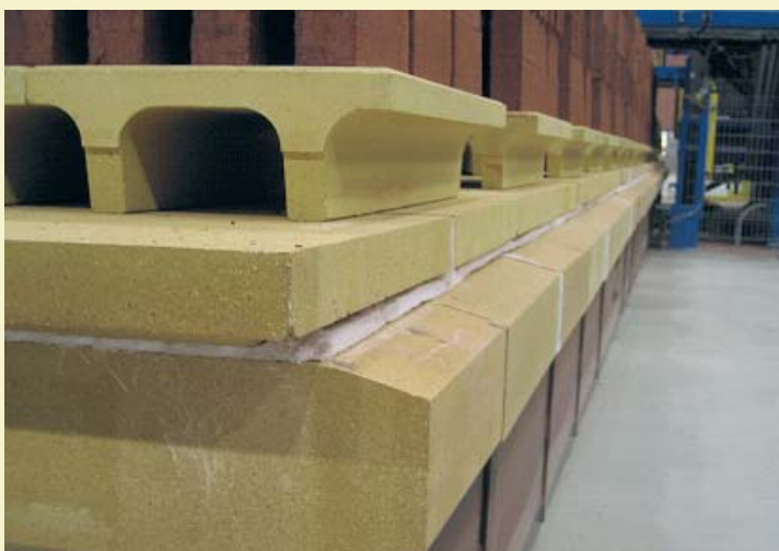
Пайн Холл, Джорджия (США) | Вагонетки для туннельных печей с нижними угловыми блоками BurcoLight
