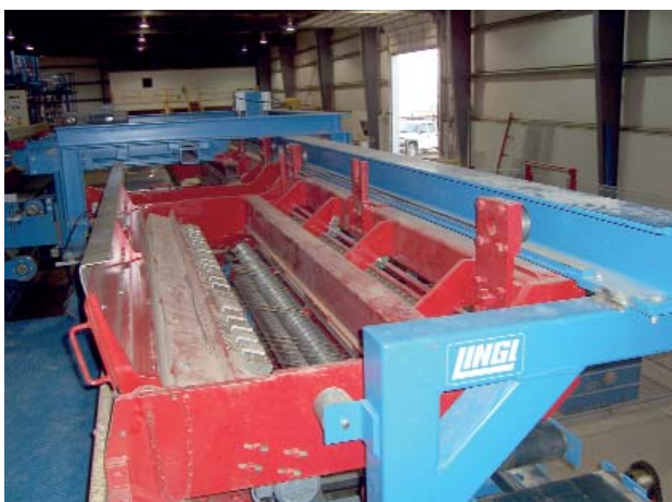
» Фасочный резак со сменными рамами и фасочным роликом
