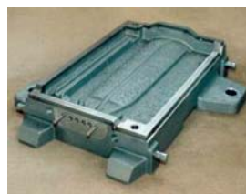
» Рабочая форма для гипсовой отливки с поливными полосами
