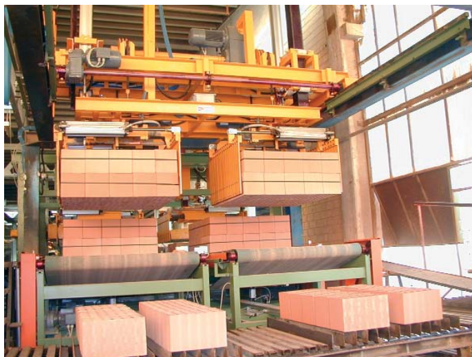
» EDILMEC: Захваты пакетировки обожженных изделий
