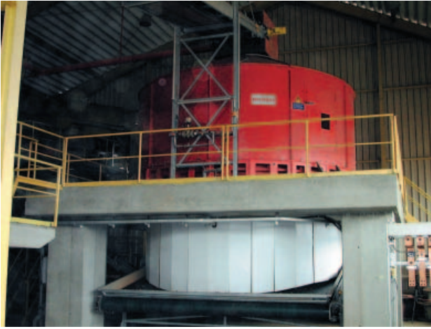
» 2. Бегуны, оснащенные разгрузочной лентой
