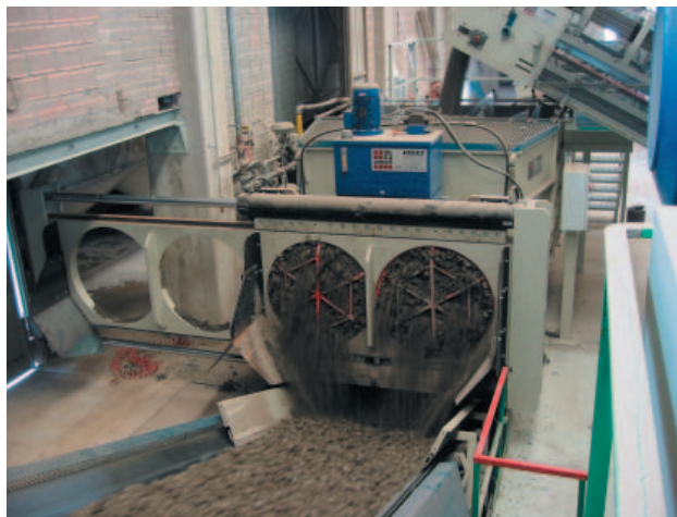
» IPA Laker: Ситовый гидромеситель типа "KFD 800"
