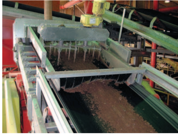
» 3. Ленточный конвейер с распределителем сырья (“Synchroquirl”)
