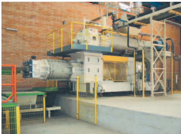
» 3. Пресс вакуумного экструдера «Combi»
