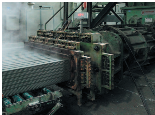
» Экструзия стеновых блоков с множественными выходами
