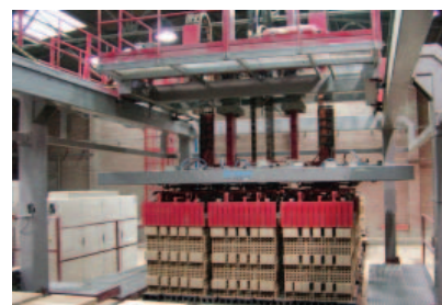
» Зажим для разгрузки/загрузки огнеупорных форм
