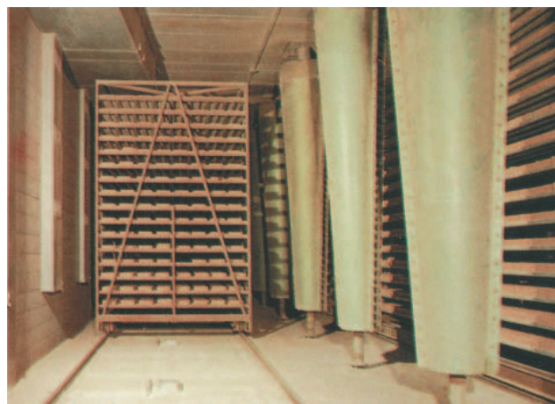
» 5. Сушильные вагонетки между тубусами ротомиксеров Solinmix в сушилке Solmix (стадия монтажа)
