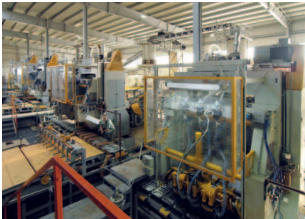
» 2 Четыре новых пресса для кровельной черепицы
