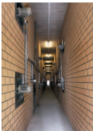
» Передний и задний ход сушилки Laminaris XL, разделенные сервисным коридором
