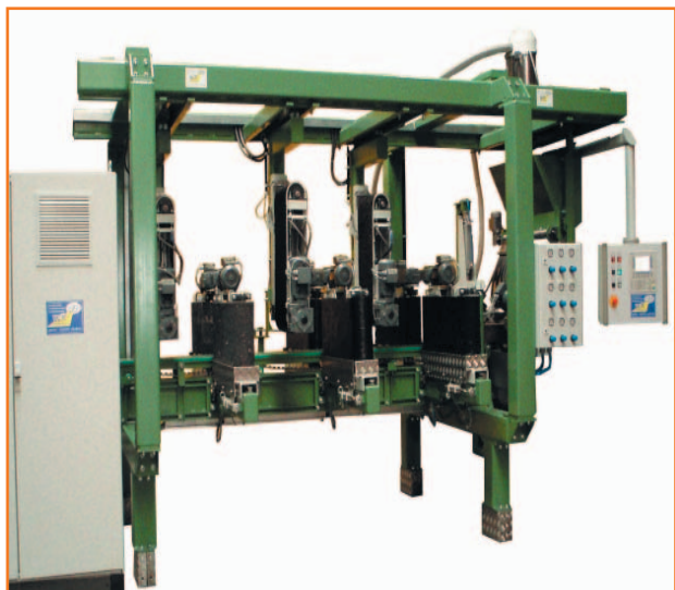
» Rustikator R06 – Профиль для изменения структуры поверхности кирпича
