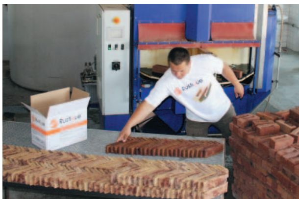
» Дистрибьюторская компания Rustique теперь использует камнерезную пилу DecoUni для производства клинкерных «ремешков» как прямого, так и углового профиля
