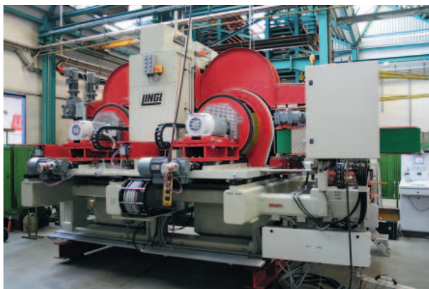
» 5 Установки, наподобие этого шлифовального модуля, проходят на заводе-изготовителе проверку с целью гарантирования быстрого ввода в действие
