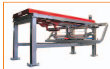
» Многострунный автомат резки
