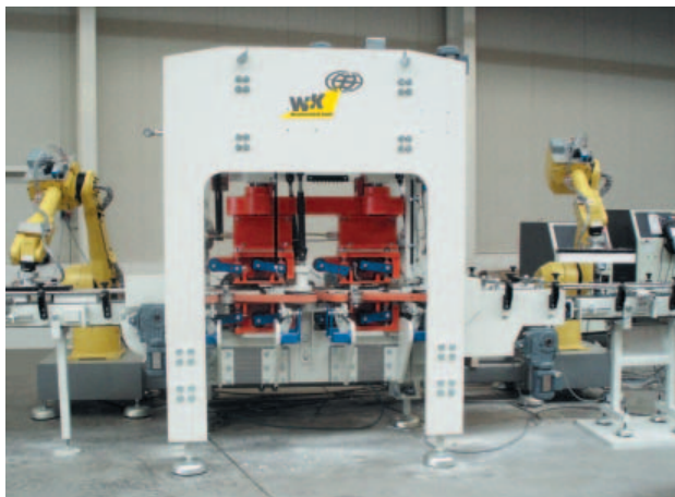
» Двух зайцев одним выстрелом: DecoSplit позволяет раскалывать и рустировать керамический кирпич одновременно
