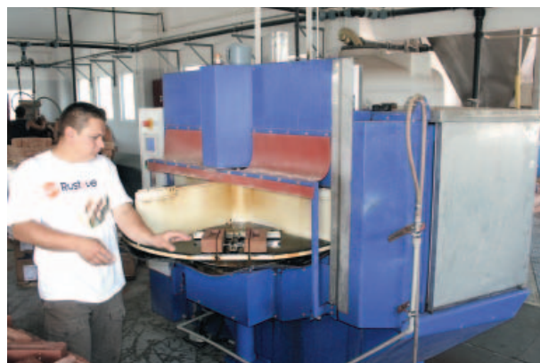
» Зафиксированная удерживающих устройством пара кирпичей поворачивается к пиле качанием стола
