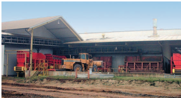
» 1. Отделение ящичного питателя: загрузка через конвейерные ленты и фронтальный погрузчик
