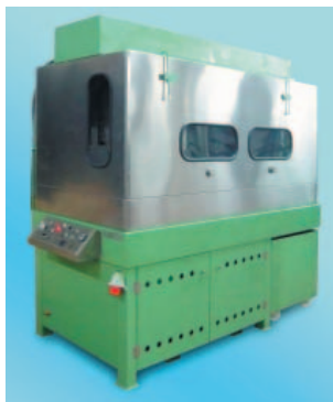
» Машина для мойки головок экструдера
