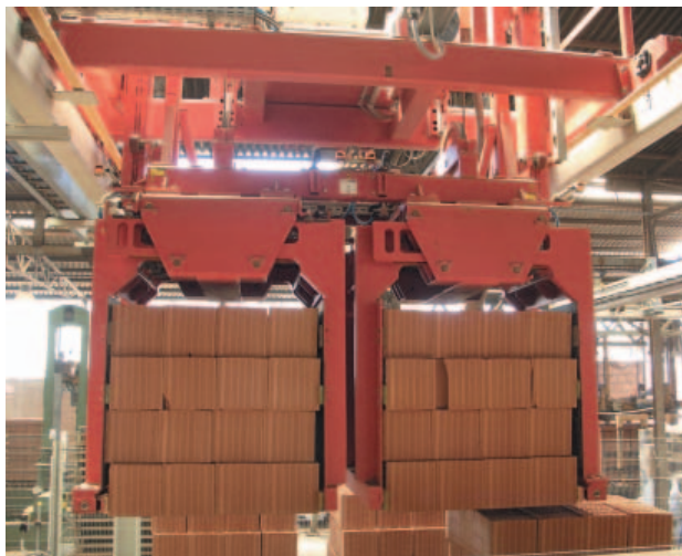
» Разгрузочный захват перемещает пакет в накопитель. Прижимные планки удерживают груз неподвижно и гарантируют его сохранность во время транспортировки
