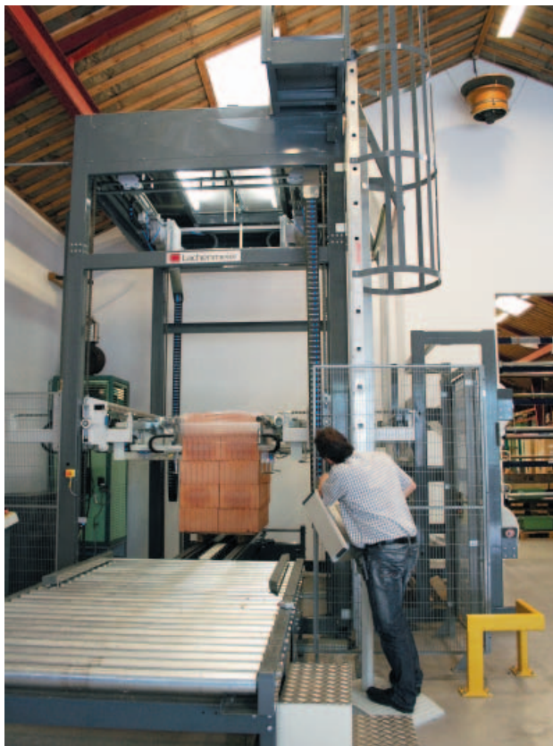
» Опытная упаковочная установка для испытаний пленки самых разных типов
