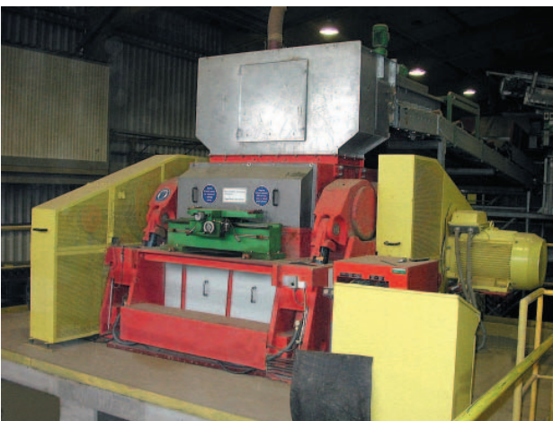
» 4. Валковая дробилка и вальцетокарный станок
