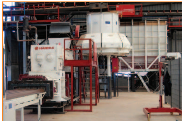
» Ящичный питатель тип BKN, круглый ситовый питатель тип BRSH 19bи вакуумный агрегат Futura II тип E 65/ 60 с вакуумным смесителем двухвалковым тип MDVG 1025f фирмы Haendle
