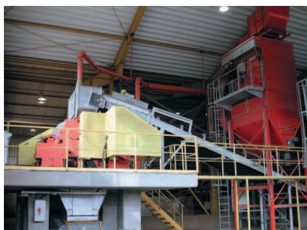
» 5. Валковая дробилка с системой пылеулавливания
