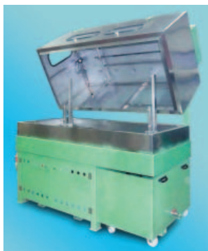
» Машина для мойки головок экструдера (открыта)
