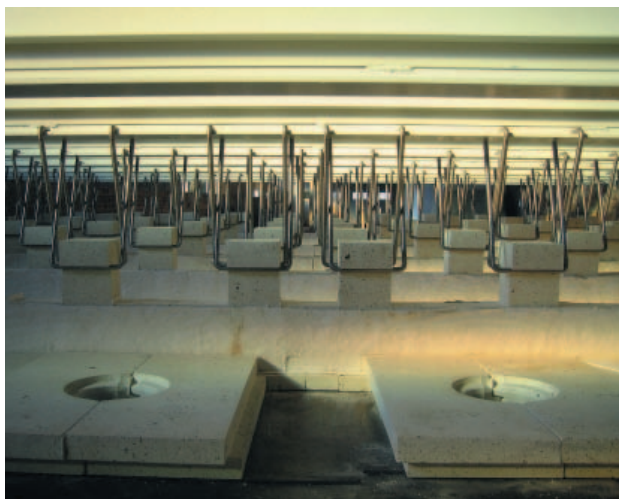
» Зона предварительного нагрева: деталь свода
