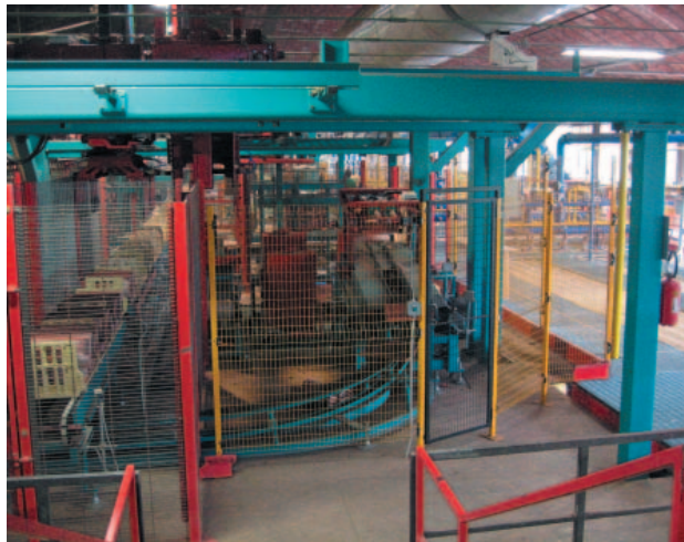
» ILCA – Италия: производительность технологической линии, макс: 5.000 плиток в час
