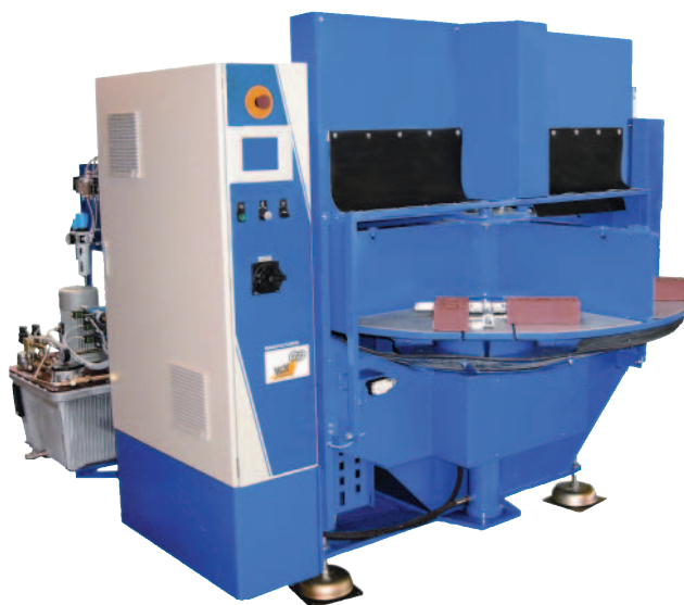
» Камнерезная пила DecoUni может распиливать широкий спектр кирпичей: клинкерные «ремешки» как прямого, так и углового профиля; продольные и поперечные кирпичные половинки; вплоть до доборных фасонных элементов
