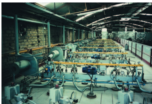
» Установка Duplo-ASNG/2, работающая как на природном газе, так и на тяжелом топливе
