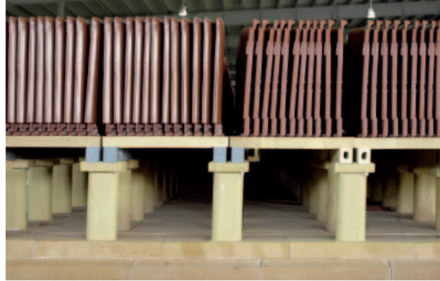
» 12 Черепица установлена вертикально с зазорами
