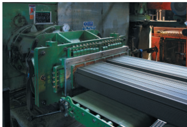
» Экструзия потолочных блоков с двойным выходом
