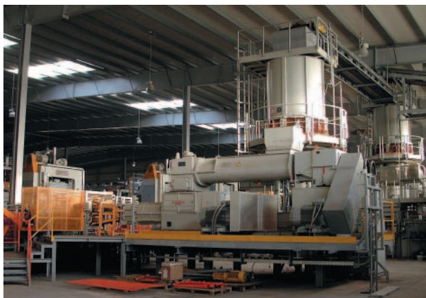
» 7. Цех формования глиняного бруса
