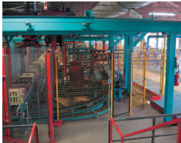
» ILCA – Италия: максимальная производительность технологической линии: 5 000 плиток в час
