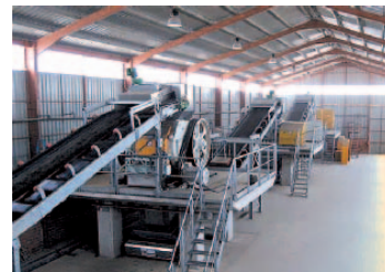
» 8 Линия из трех вальцевых мельниц, установленных в ряд
