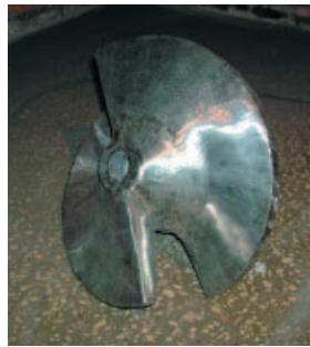
» Бронированные шнек и ру- башка
