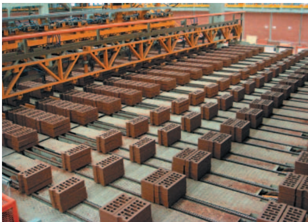
» 4 Разгрузка обожженного кирпича с разбивкой рядов для проверки цвета
