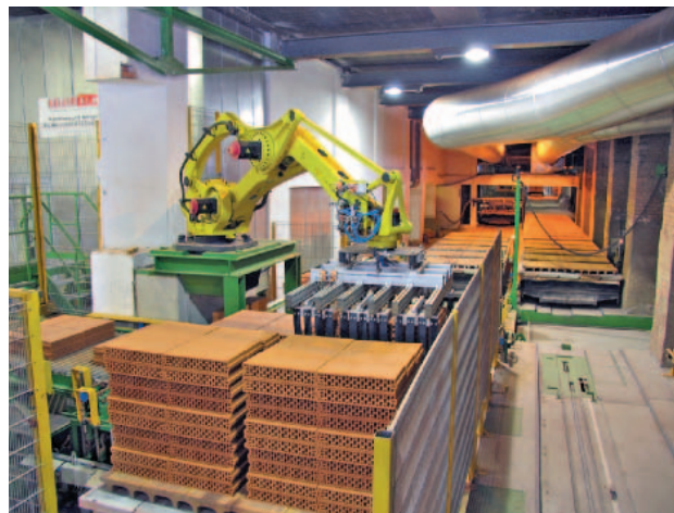
» 6 Роботизированный участок разгрузки облицовочного кирпича (компания Keller HCW)
