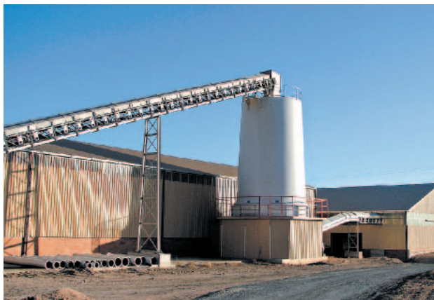
» 10 Глиняный бункер AGR 65c, питающий конвейер с внешней защитой и параллельными мостками
