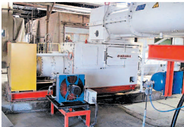
» 12 Вакуумный экструдер Futura, смеситель у прессы
