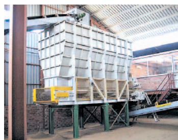
» 5 Ящичные питатели, используемые как буфер для накопления предварительно измельченной глины
