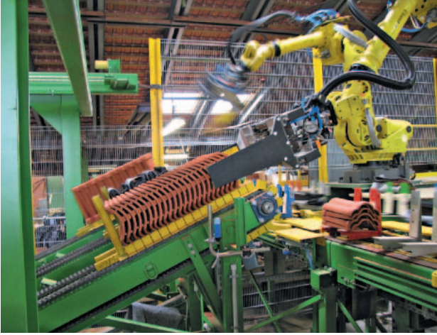
» 7 Инновационная технология разгрузки и сортировки керамической кровельной черепицы (компания Keller HCW)
