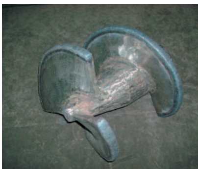
» Головка шнека после восстановления
