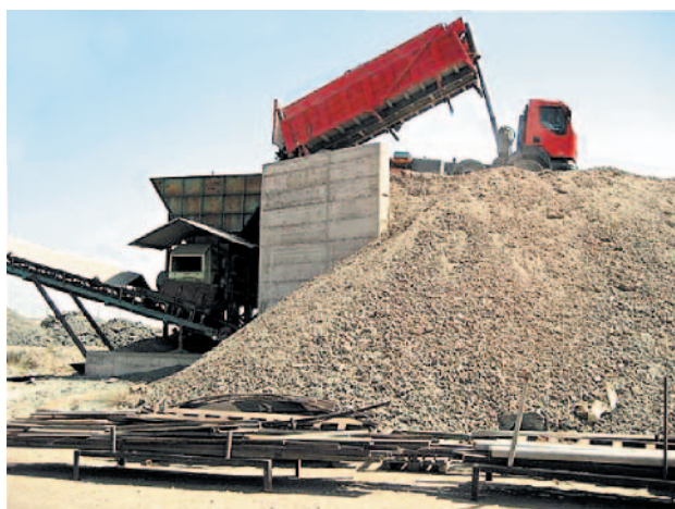
» 1 Доставка мергелистой глины на самосвалах и разгрузка в ящичный питатель
