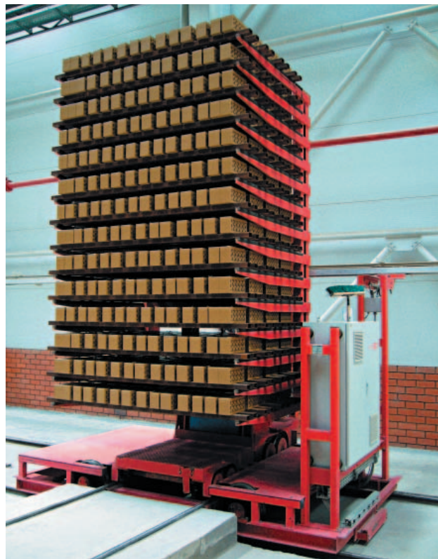
» 4 Тележка на рельсовом ходу для подачи загруженных несущих элементов в сушильные камеры
