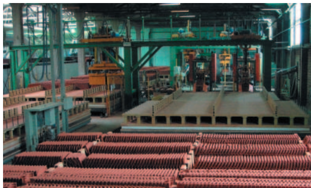
» Siceram – Румыния: Производительность технологической линии: 3 000 единиц кровельной черепицы в час
