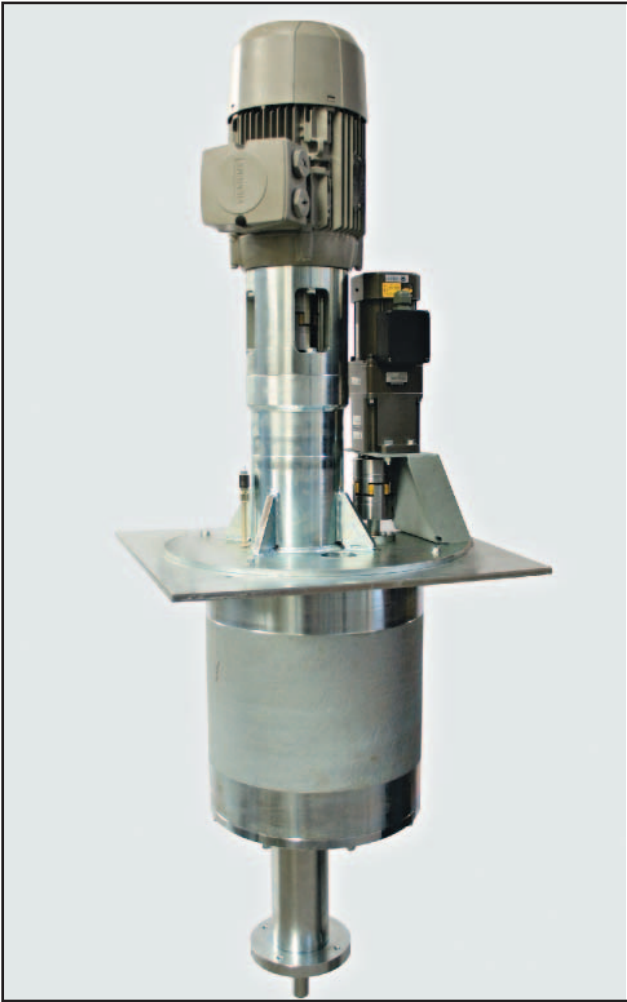
» 1 Привод оборудован электромотором самого высокого класса по производительности (EFF1)
