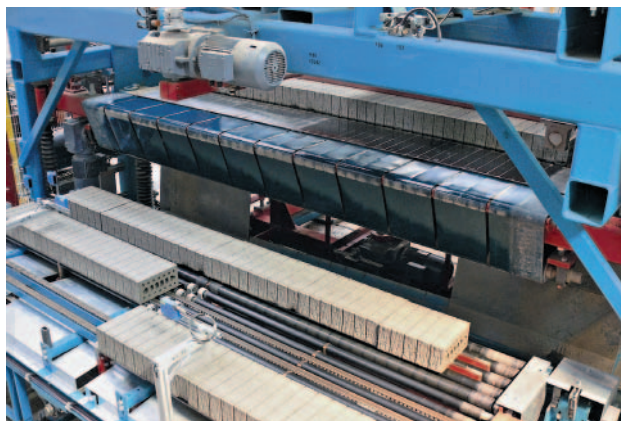
» 1 Резчик сплошного прохода Lingl с группировкой необожженных изделий
