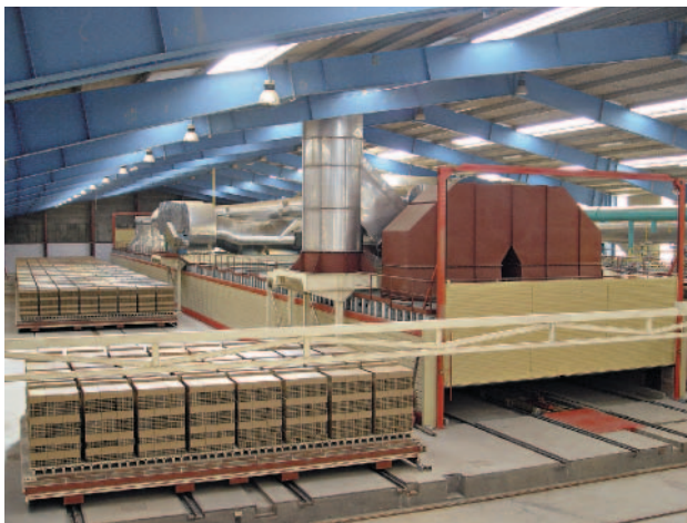
» 5 Подогреватель на заводе с производительностью 1000 т в день, область Леон, Испания (компания Equipceramic)
