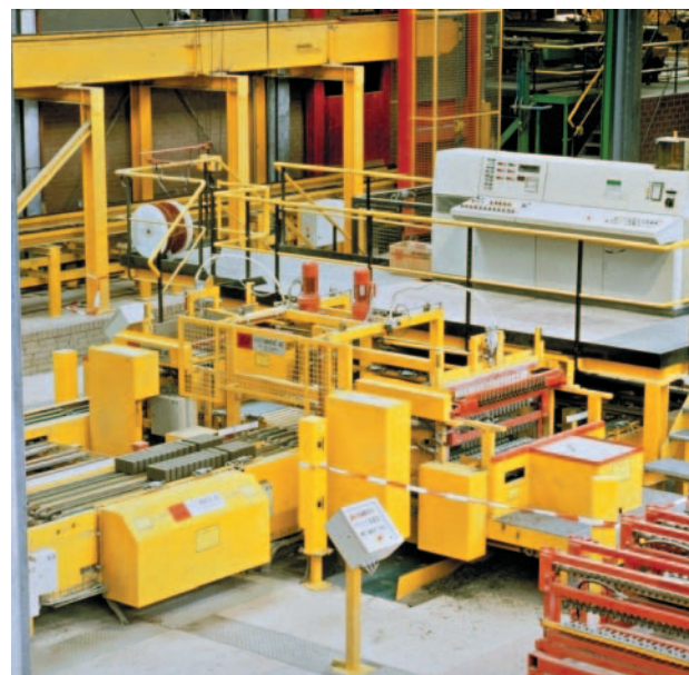
» 6 Сдвоенный Multicut для производства тротуарной плитки
