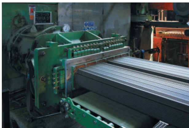
» Экструзия потолочных блоков с двойным выходом
