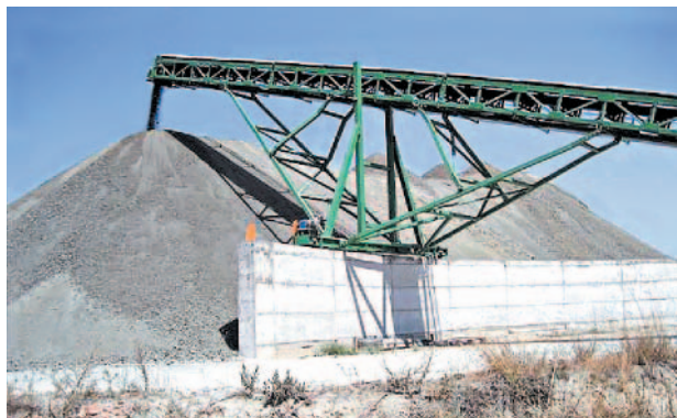
» 2 Поворотный конвейер для разгрузки глины в отвал
