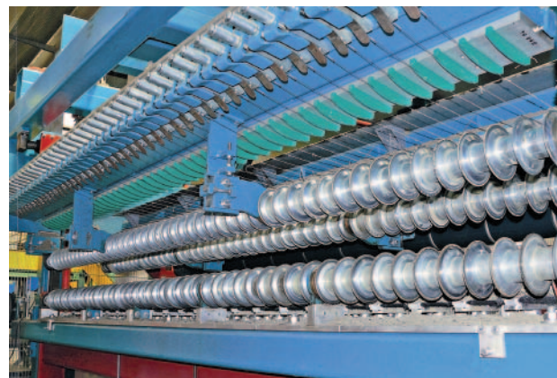
» 2 Резчик сплошного прохода Lingl – резательный стол с вальцами для шпунтовки
