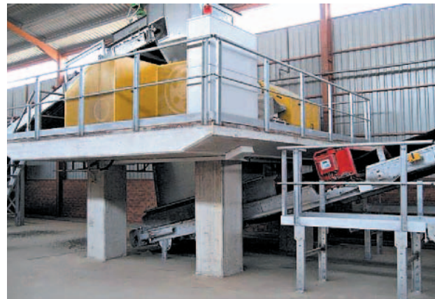
» 9 Вальцевая мельница Beta типа WF 10120e, питающий ленточный конвейер с распределителем материала Synchro, разгрузочный конвейер с металлодетектором
