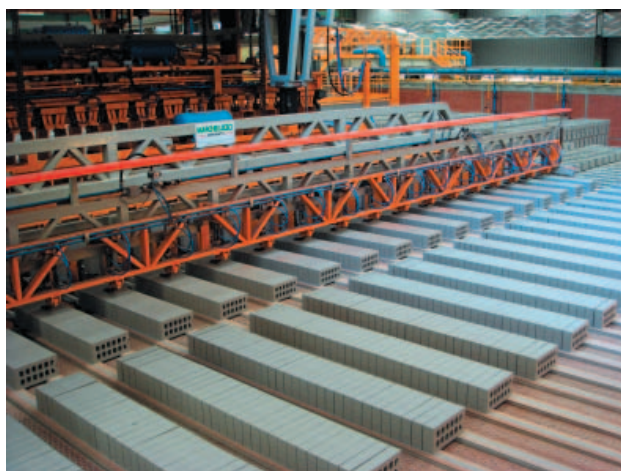
» 2 Вид на садочную машину с несколькими печными вагонетками загруженными высушенным кирпичом
