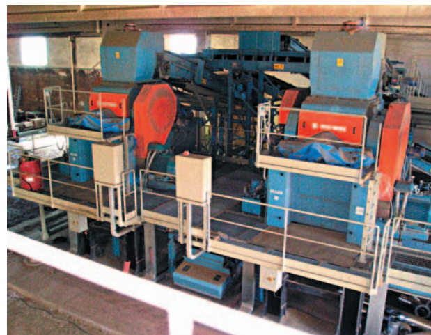
» 5 Вальцевая группа, изготовленная компанией High Speed Rolls Velox 10/12
