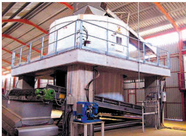
» 7 Бегуны HMI 2170c с разгрузочной камерой и ленточным конвейером
