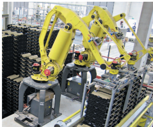
» 4 Автоматическое центрирование черепицы, предназначенной для сушки (компания Ceric)
