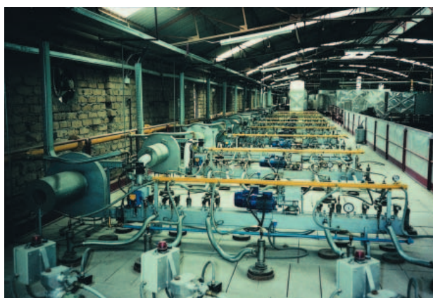
» Установка Duplo-ASNG/2, работающая как на природном газе, так и на тяжелом топливе
