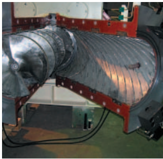
» Бронированные шнек и ру- башка
