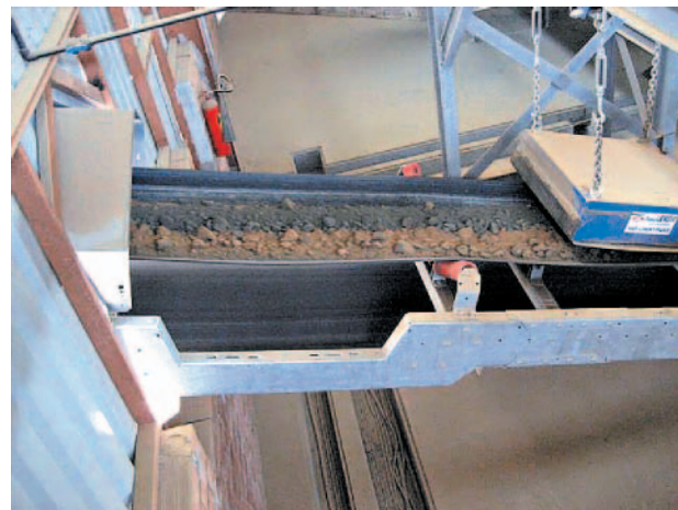
» 6 Магнит, извлекающий металлические включения на ленточном конвейере, питающем бегуны
