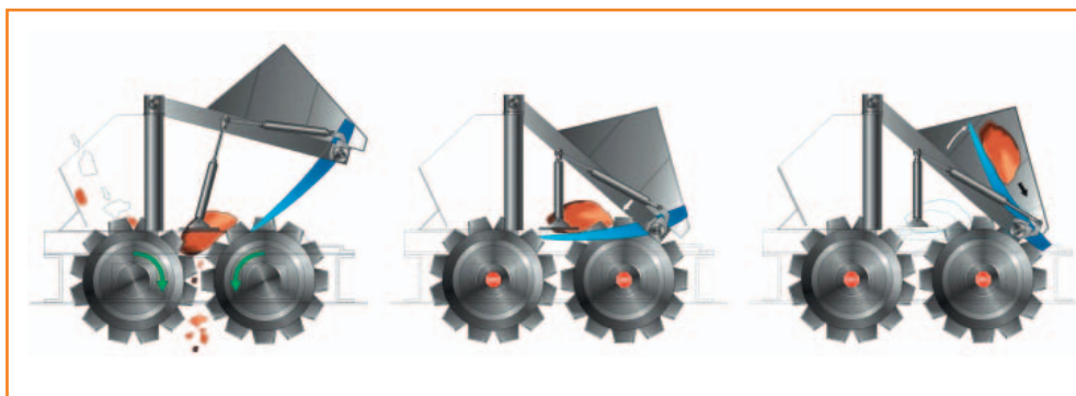
» Принцип работы камнеотделительной дробилки типа WSB 816b
