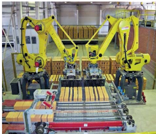
» 9 Разгрузка печных вагонеток, автоматический режим работы
