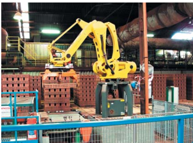
» 3 Роботизированный автомат-садчик для лицевого кирпича
