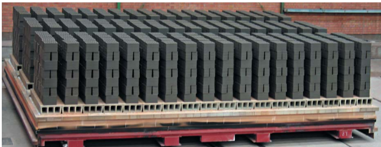
» 2 Серый кирпич с голубовато-металлическим оттенком, полученный путем восстановительного обжига
