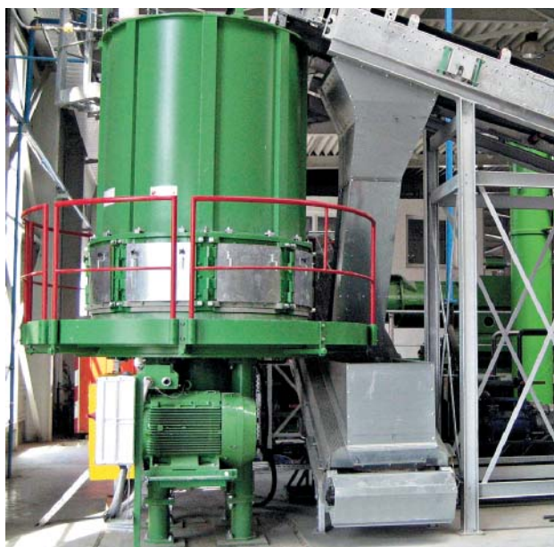
» 11 Глинорастиратель типа BRSH 19b с крышкой, закрывающей решетку для предотвращения высыхания глины, с желобом для подачи материала мимо глинорастирателя и реверсивным ленточным конвейером
