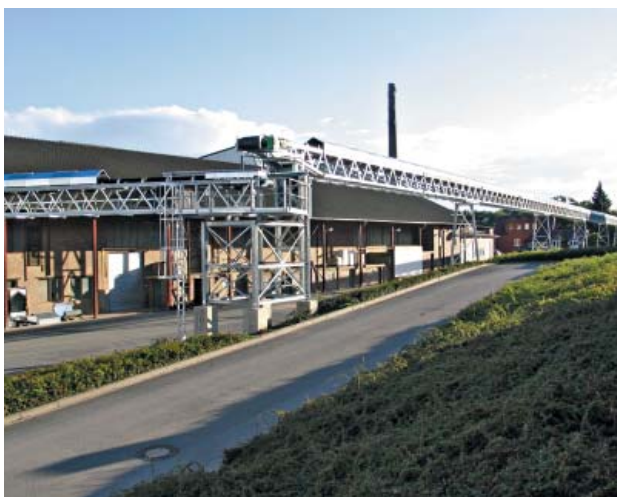
» Ленточный транспортер с размахом 30 м (Lafarge)
