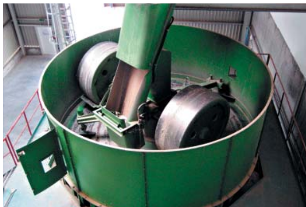
» 1 Бегуны типа HMI 2080d фирмы Händle со свободноповешенным подводящим транспортером и вращающимся вместе с ними лотком для загрузки материала
