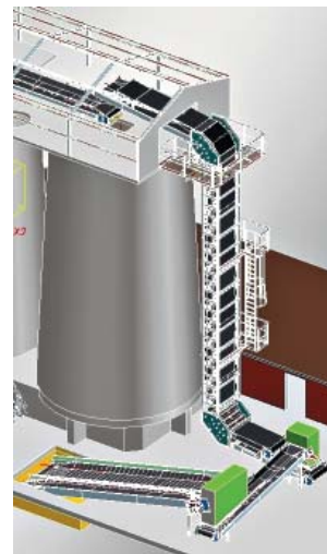
» Двухленточный конвейер в качестве бункерного питателя (Lafarge)
