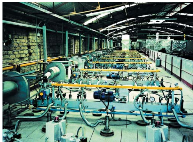
» 3 Установка Duplo-ASNG/2, работающая как на природном газе, так и на тяжелом топливе
