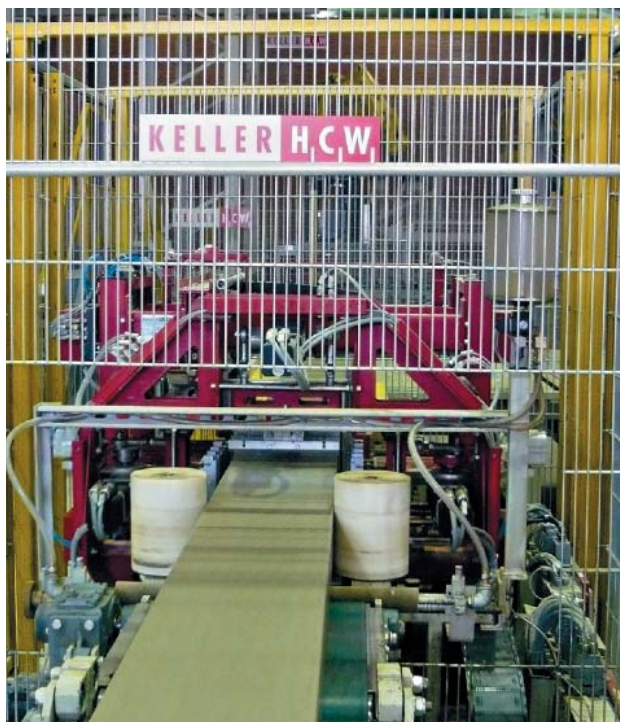
» 2 Универсальное отрезное устройство с фаской
