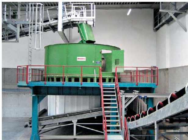
» 6 Бегуны мокрого помола типа HMI 2080d со свободно подвешенным питающим конвейером, подающий желоб вращается одновременно с конвейером, снабженным ламельной шторой
