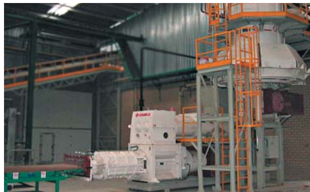
» 2 Установка формования фирмы Händle, состоящая из вакуумного агрегата Futura II типа E65a/60/MDVG 1025f и кругового ситового питателя типа BRSB 19b
