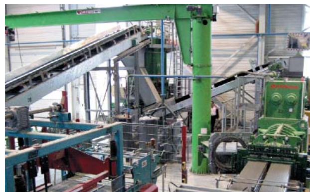
» 12 Участок формования: комбинированная вакуумная установка с экструзией двойного бруса, с отведенной в сторону второй экструзионной головкой слева, впереди резчик и еще одна резательная установка, готовая к работе
