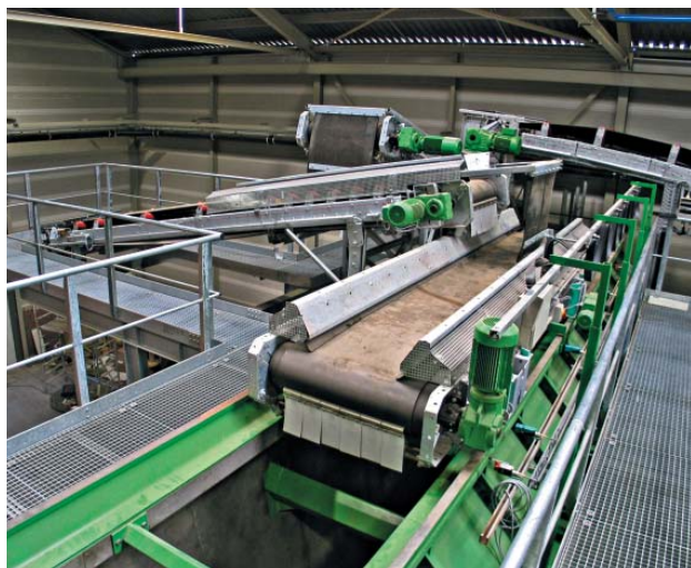
› Станция загрузки ящичного питателя (Huissenswaard, Нидерланды)
