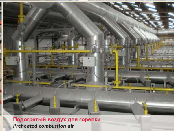
Рециркуляция горячих газов Hot air circulation system
