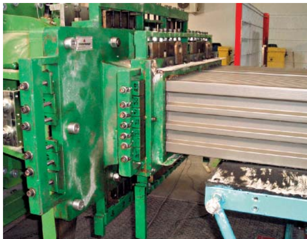
» 13b Регулирующий мундштук на выходе двойного бруса
