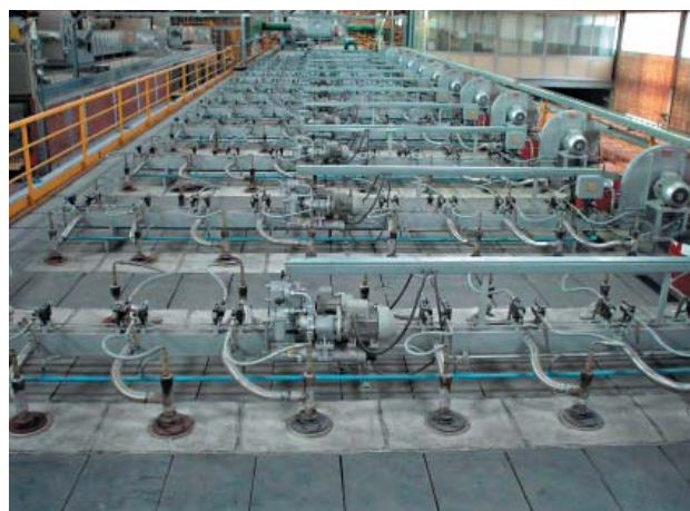
» 4 Горелки для газифицированного топлива типа ASN/6
