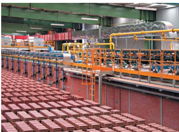
» 5 Красный кирпич, обожженный в атмосфере, обогащенной кислородом
