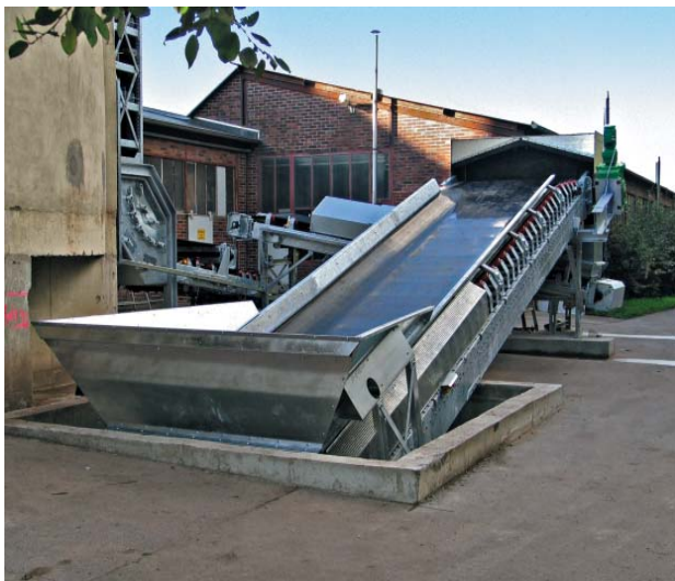
» Приемное устройство транспортера для разгрузки автомобилей (Lafarge)
