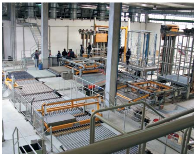
» 1 Подготовка полуфабриката к сушке и обжигу
