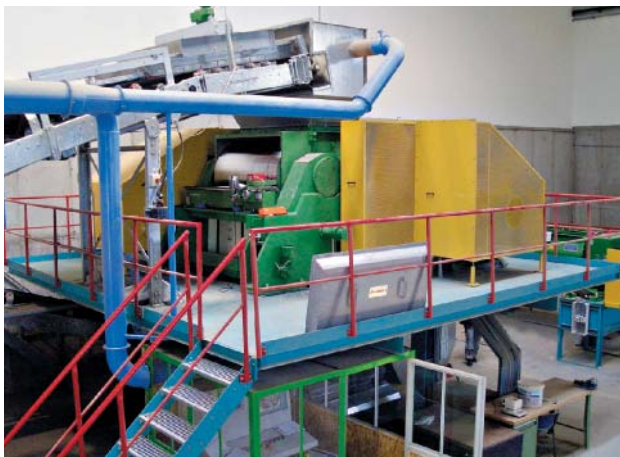
» 8 Вальцы супертонкого помола шарнирного типа Alpha II модели WFZH 10150d с вальцетокарным станком типа WDH 150 pa
