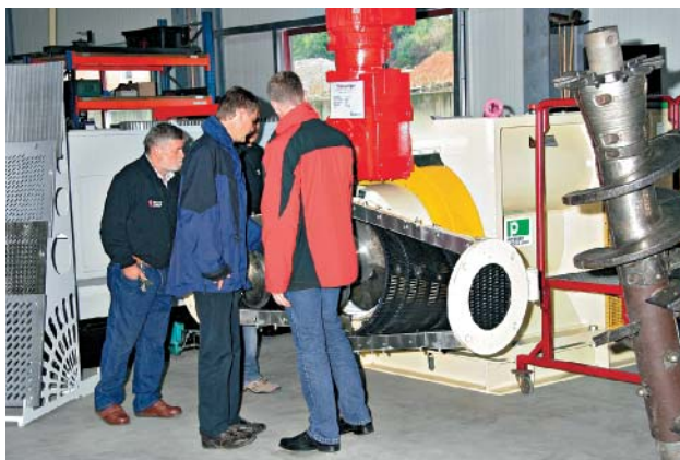
» 2 Покупатели изучают глиноочиститель Zwickau ZAR 650 с диаметром цилиндра 650 мм
