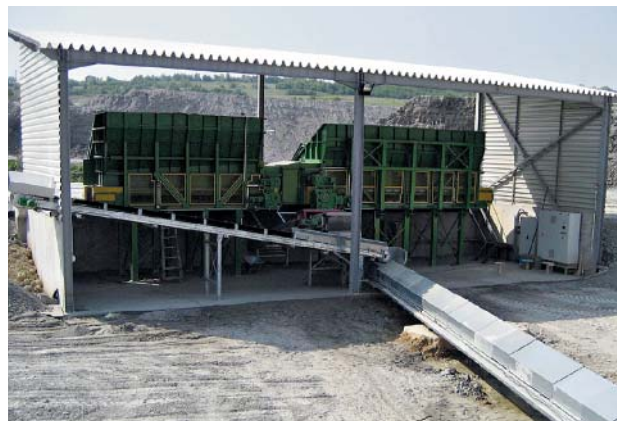
» 3 Участок ящичных питателей в карьере – конусы на открытом воздухе видны на заднем плане, на переднем плане система транспортных конвейеров
