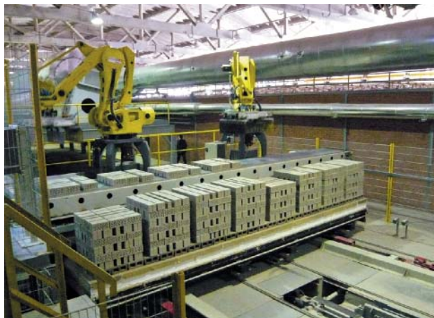
» 6 Робот-садчик, автоматический режим работы
