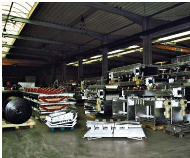
› Благодаря модульной конструкции оборудование можно разобрать на малогабаритные узлы для удобства отгрузки
