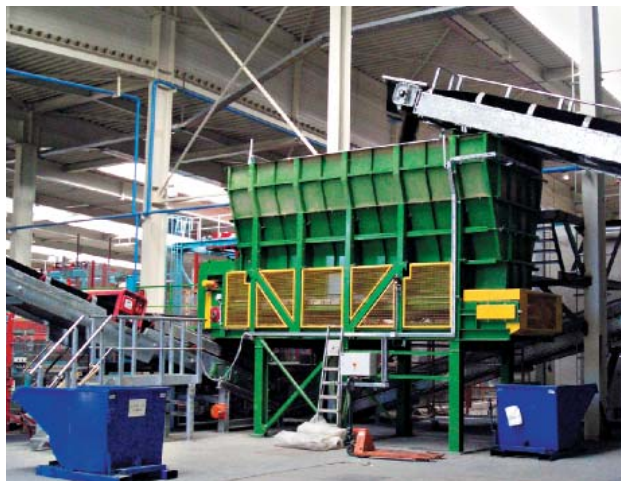
» 10 Ящичный питатель на массоподготовительном участке предназначен для хранения и дозирования материала, поступающего из шихтозапасника, и отходов после резки
