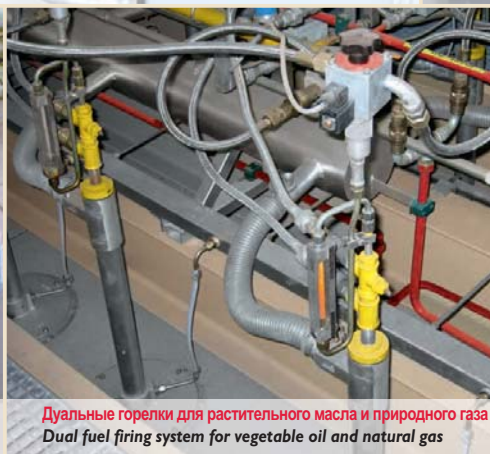
Подогретый воздух для горелки Preheated combustion air
