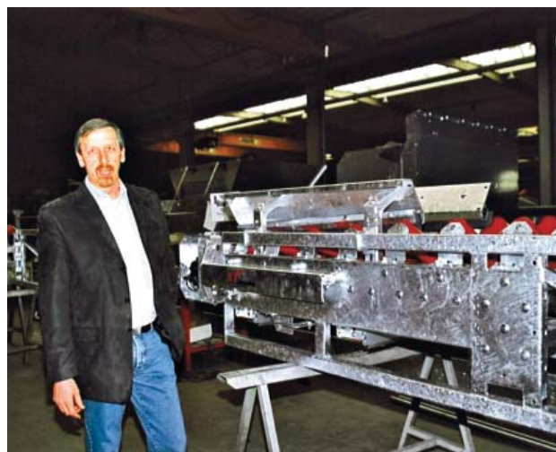
» Котловина конвейера VHV служит как пост подачи материала, а натяжное устройство ленты располагается сбоку; обе меры, по словам Бернарда Вельтмана, позволяют сэкономить немало места
