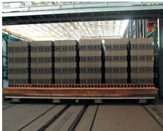
» 2 Печная тележка, загруженная перегородочными блоками
