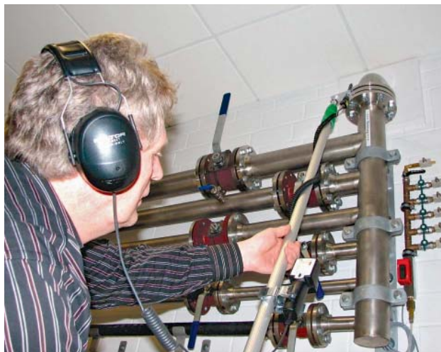
» 8 Обнаружение утечек на участках негерметичного соединения
