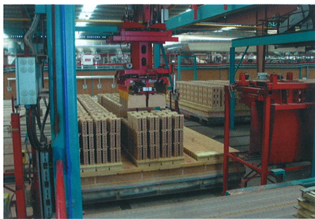
» 2 Разгрузка при помощи специального захвата
