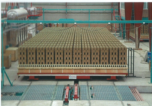
» 1 Туннельная печь, загруженная кирпичом типа Caravista
