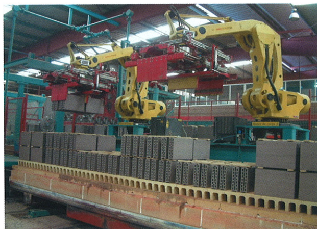
» 6 Роботизированный процесс садки
