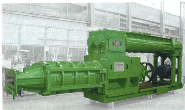
» Новый экструдер, оснащенный автоматикой влагурегулирования и частотно-регулируемым приводом
