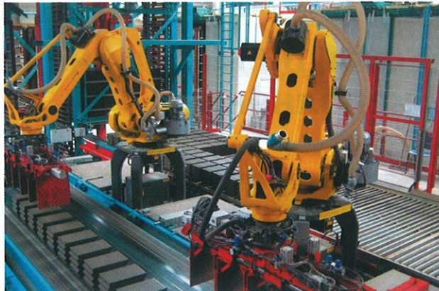
» 2 Загрузка и разгрузка поддонов для сушки
