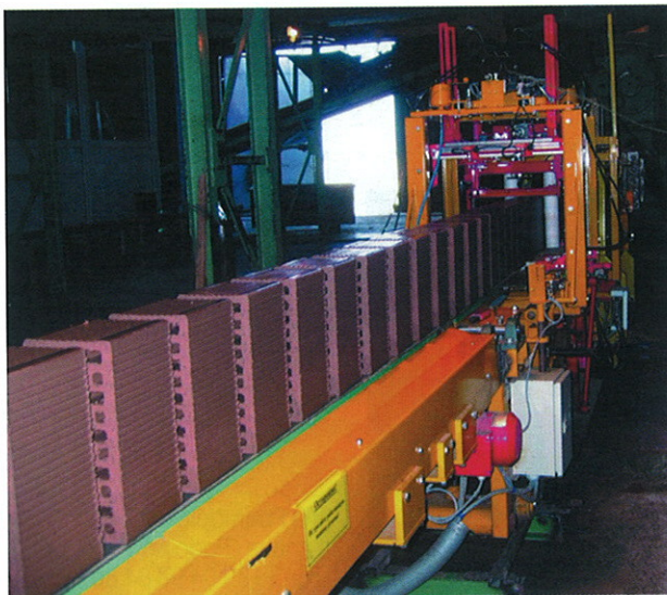
» 1 Универсальный резчик с системой программирования, модель «АМ»
