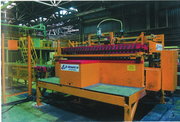
» 3 Высокопроизводительный резчик лицевого кирпича и дорожного клинкера, модель «Freymatic Multicut»
