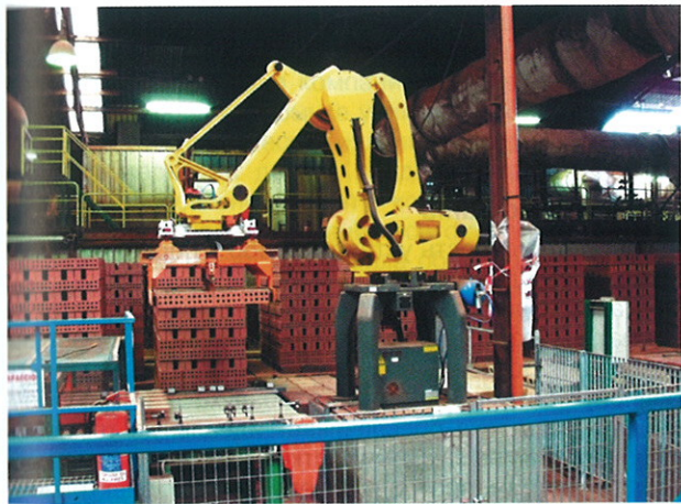
» 3 Роботизированный автомат-садчик для лицевого кирпича
