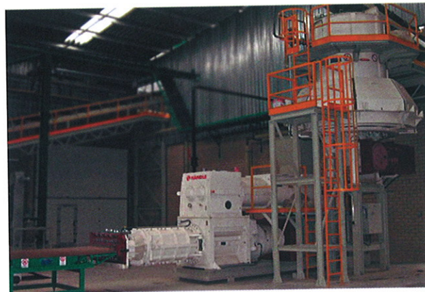
» 2 Установка формования фирмы Händle, состоящая из вакуумного агрегата Futura II типа E65a/ 60/ MDVG 1025f и кругового ситового питателя типа BRSH 19b
