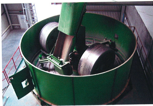
» 1 Бегуны типа NMI 2080d фирмы Händle со свободноповешенным подводящим транспортером и вращающимся вместе с ними лотком для загрузки материала
