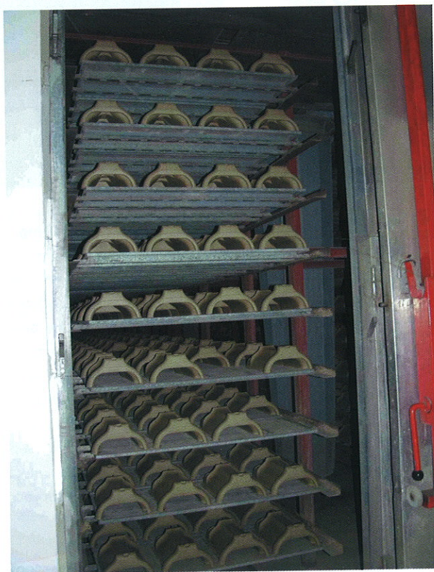
» 1 Выгодно: стационарные технологии измерения влажности вносят решающее преимущество в процесс сушки кровельной черепицы
