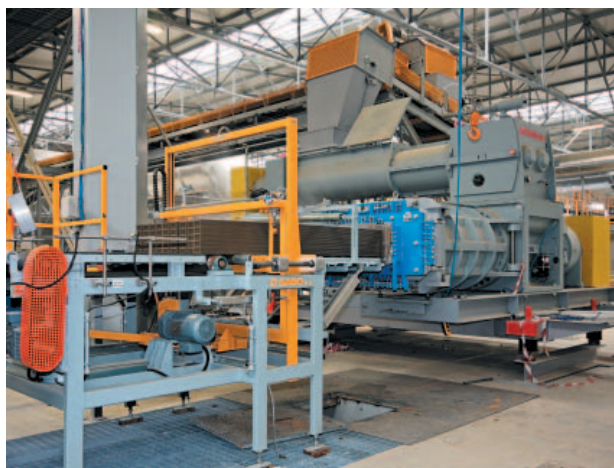
» 4 Экструдер со шнеком 700 мм
