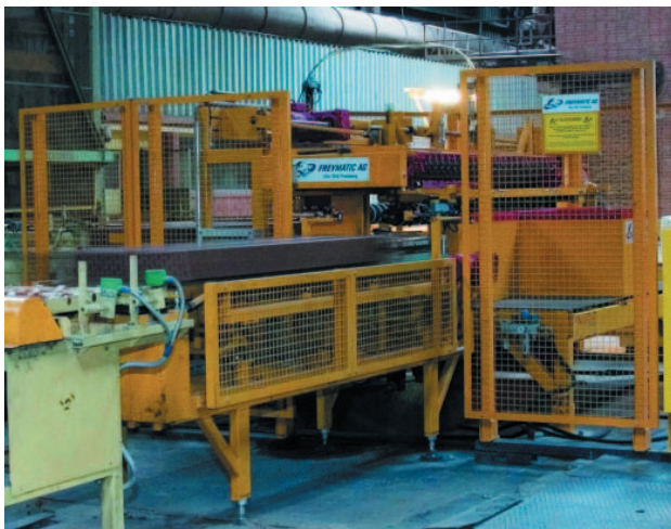
» 2 Многострунное разрезное устройство Multicut
