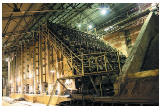
» 1 Силосный питатель вместимостью 2 000 м 3 , завод СККМ, г. Самара
