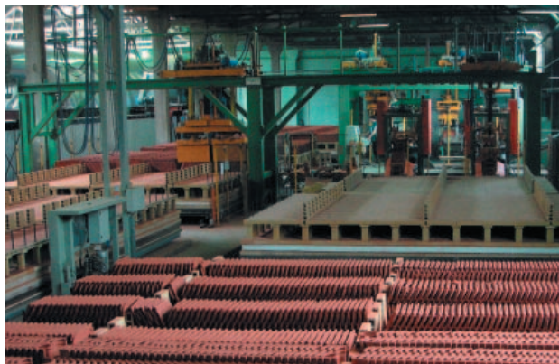
» 2 Siceram – Румыния: производительность технологической линии – 3000 единиц кровельной черепицы в час
