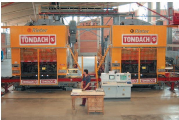
» 8 При помощи двух независимых штамповочных прессов можно прессовать одновременно два разных типа кровельной черепицы
