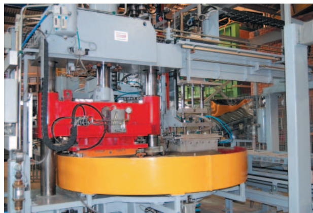
» 13 Штамповочный пресс для изготовления доборочных элементов
