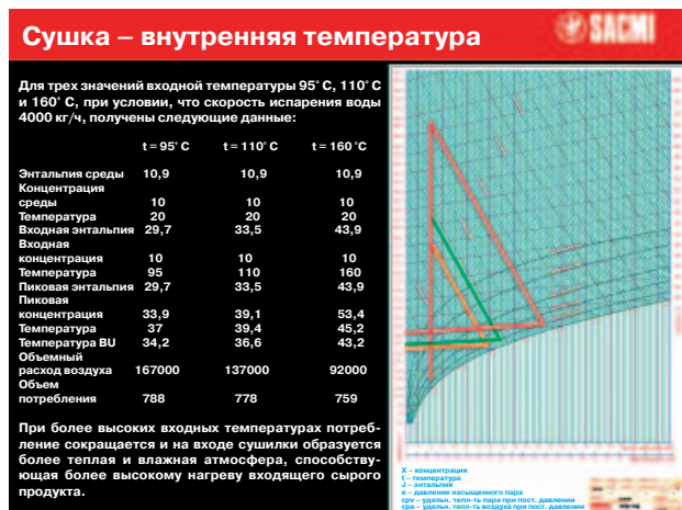
» 10 Сравнение расходов при сушке в трех различных температурных режимах
