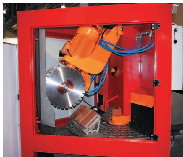
» 2 Рабочая часть установки DecoBasic
