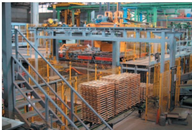
» 1 RDB Италия: Производительность модуля: 20 000 единиц в час
