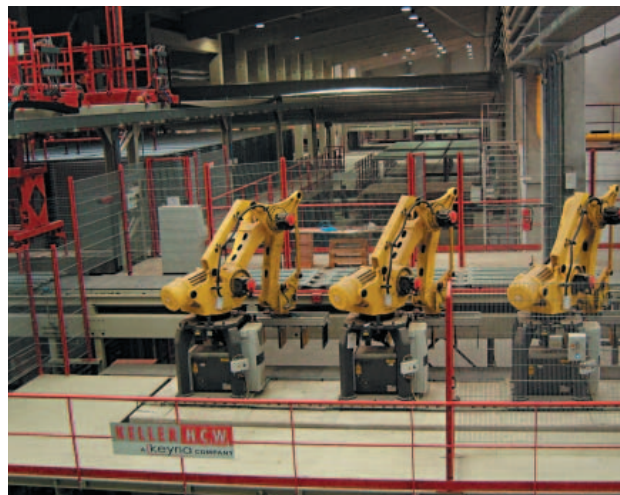
» 5 Загрузка поддонов для сушки четырехосевым промышленным роботом
