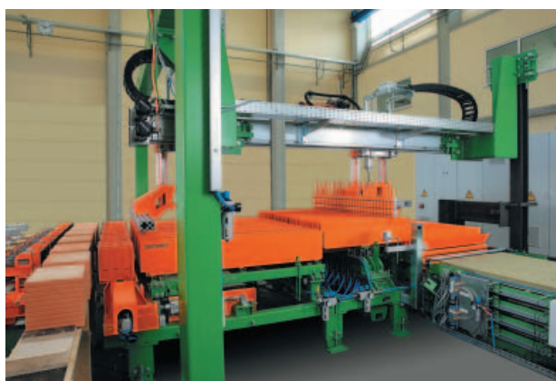
» 1 Участок заполнения кирпича
