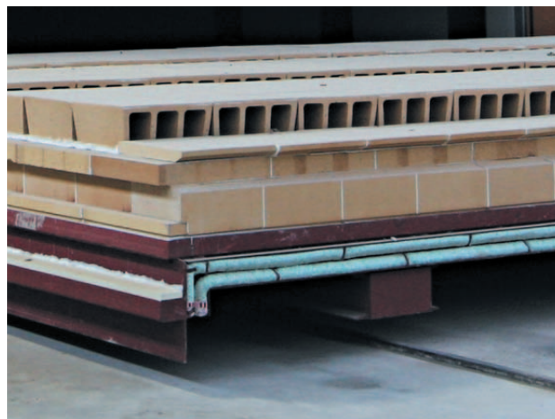
» 13 Система лабиринтного уплотнения на печных вагонах
