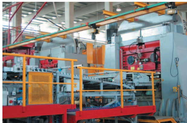
» 7 На двух штамповочных прессах DR6/200 с тремя пресс-формами прессуется крупноразмерная черепица
