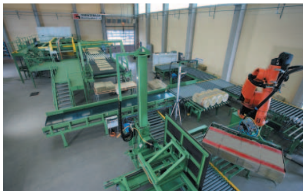
» 2 Теплоизоляция из минеральной ваты – роботизированная укладка на поддоны
