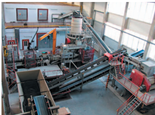
» 3 Отделение формования: ящичный питатель, валковая дробилка, круглый сетчатый питатель и шнековый пресс
