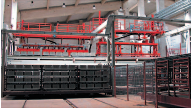
» 8 Разгрузка вагонеток сушилки и поддонов для сушки
