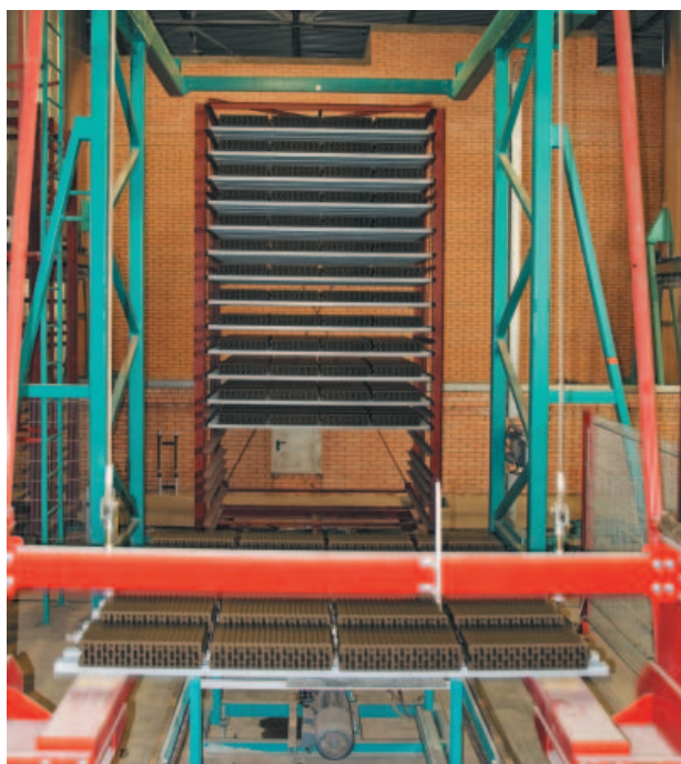
» 3 Загрузочный лифт на мокрой стороне
