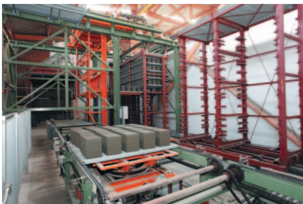
» 5 Автоматы для погрузки на стеллажи высушенных изделий («Iasi» Румыния)
