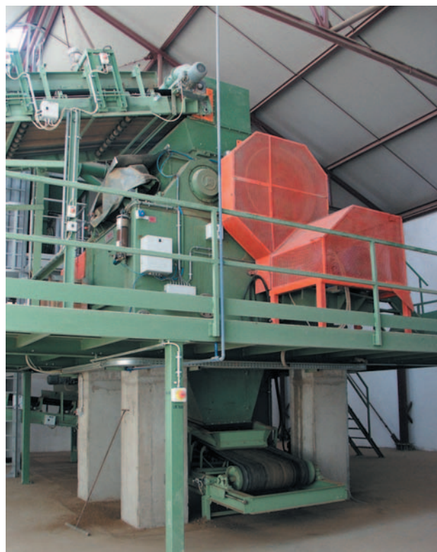
» 2 Валковая дробилка для тонкого измельчения типа 14LVB
