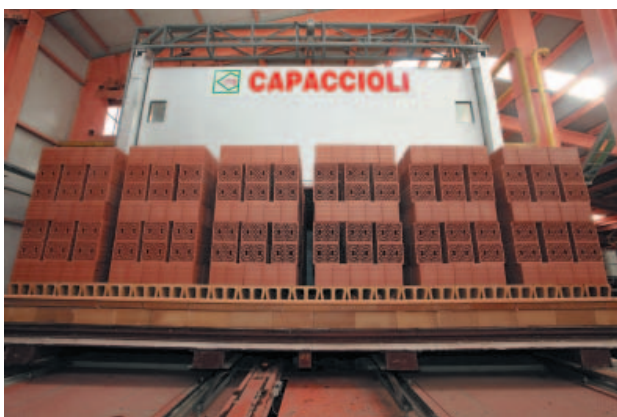
» 4 Вагонетка с обожженными изделиями на выходе из печи («Iasi» Румыния)
