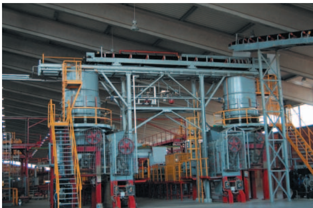
» 6 Две параллельные формовочные линии начинаются с глинорастирателей
