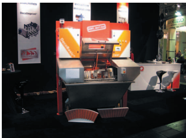
» 1 Запатентованная установка DecoBasic для резки клинкерных «ремешков» прямого и углового профилей
