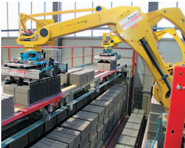
» 9 Четырехосевой промышленный робот для укладки заготовок на печные вагонетки
