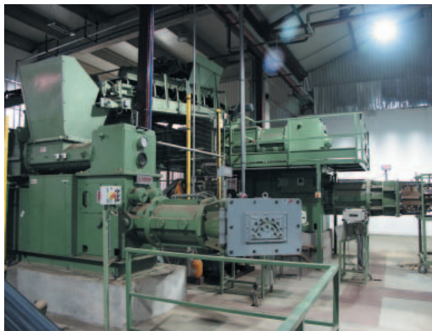
» 3 Экструдер типа Тесно Т 350 – Т 550
