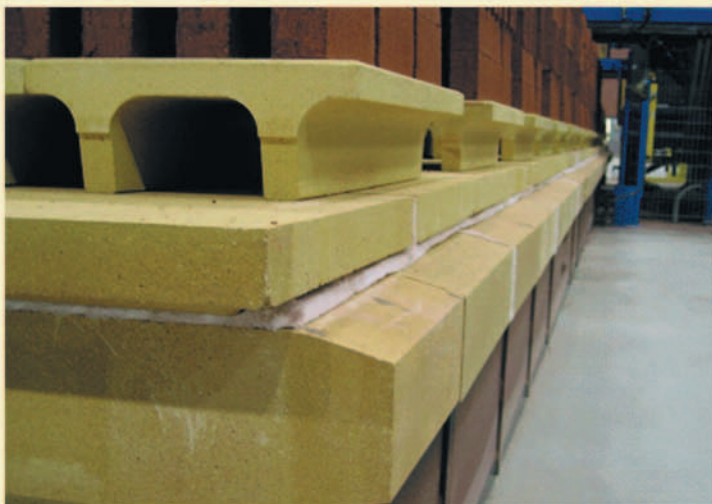
Бораль Брикс, Печь Гарроп (США) | За счет применения сорта BURCOLIGHT была достигнута экономия общих расходов энергии до 9,5 %
