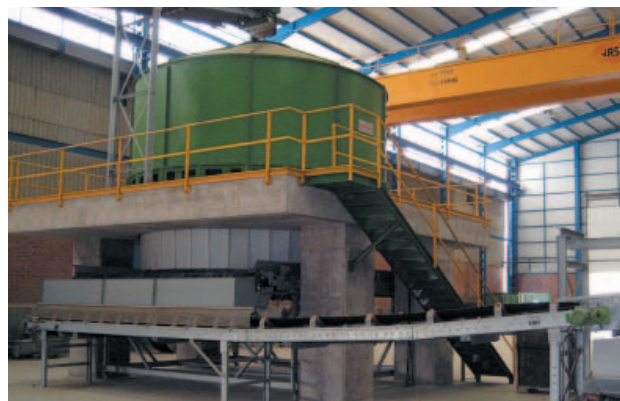
» 2 Бегуны Händle типа HMSI 2180c для измельчения, смешивания и достижения однородности сырья различных сортов, от мягких до твёрдых
