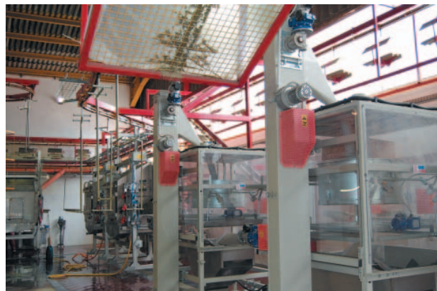
» 14 Оборудование для ангобирования доборочных элементов
