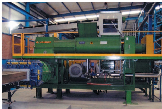
» 1 Вакуумный агрегат Händle, состоящий из экструдера типа E 75a/70 и вакуумный смеситель двухвальный типа MDVG 1015d поперечного расположения
