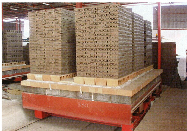
»8 Carico mattoni "half-brick" su carrello forno
