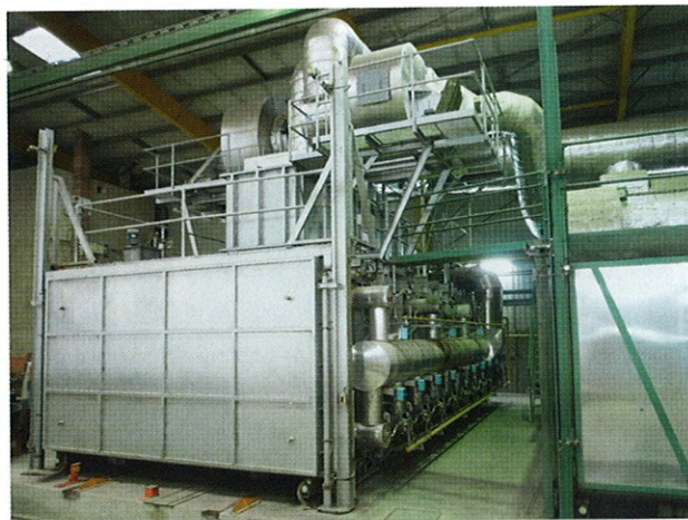
»4 Forno a suola mobile con preriscaldamento dell'aria di combustione a fino a 400 °C ed essiccatoio a camere senza bruciatore supplementare (per canne fumarie)
