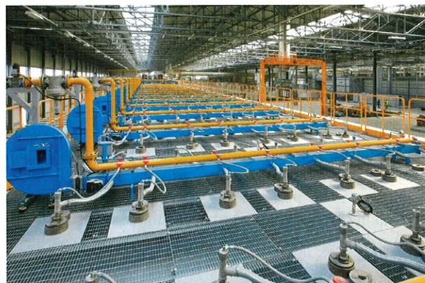
»9 Forno: bruciatori zona cottura
