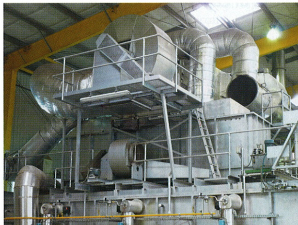
»5 Sistema di due scambiatori di calore del tipo gas-aria per gas di scarico con temperature fino a 1300 °C
