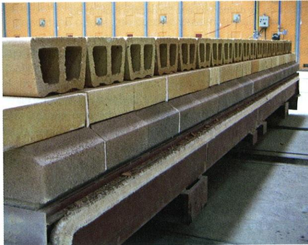
»6 Struttura di un carro per forni a tunnel
