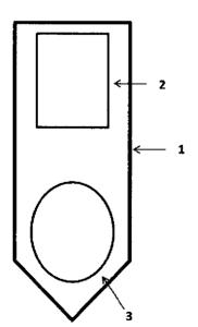
(57) Hauptanspruch: Stromspeicher-Ziegel, dadurch gekennzeichnet, dass er aus dem Ziegelgrundkörper (1), der Stromspeichereinheit (Akkumulator) (2) und der Solarzelle (3) besteht.
