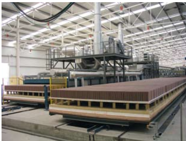
› Tunnel kiln, 120 m long, with dryer for split tiles › 120 m langer Tunnelofen mit Trockner für Spaltplatten
