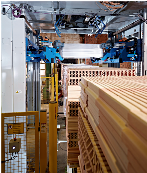
»6 La Beumer stretch hood M assure un emballage de palettes efficace. Elle place une housse étirable sur 80 palettes/heure
