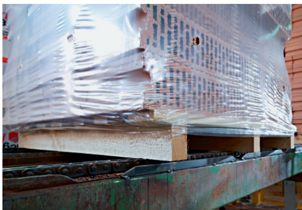
»5 La housse est étirée sur toute la charge palettisée, jusque sous la palette. Cela assure une excellente protection et stabilité des charges
