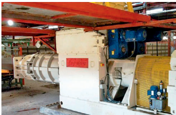
»3 Sur l'étireuse Combi 077S, la chambre à vide et le corps principal de l'hélice notamment ont bénéficié de nouvelles améliorations
