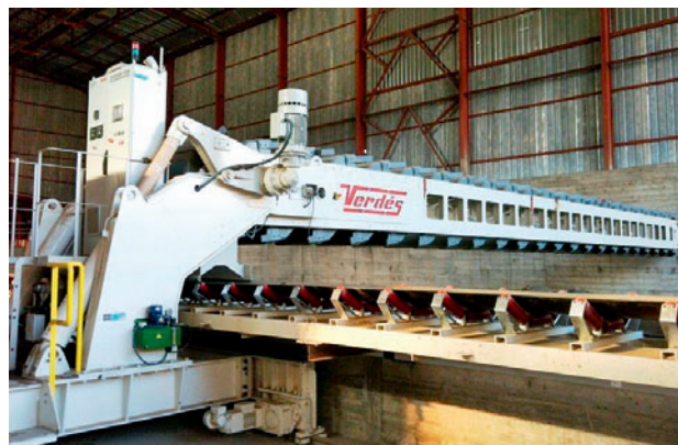
»4 L'excavateur à godets de Verdés
